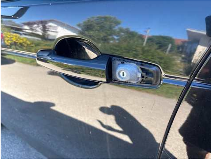
Fahrtür (Anderer Schaden): Abdeckung fehlt
