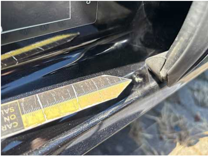
Schweller links (Kratzer, Lackschaden)
