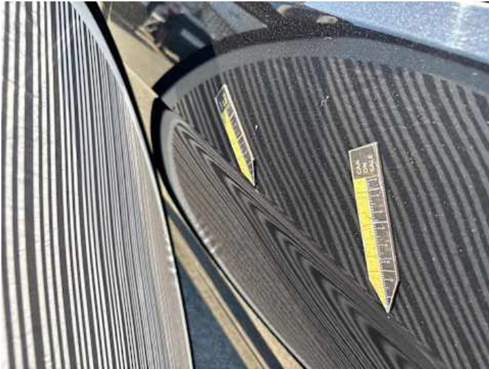
Fahrtür (Delle, Kratzer)
