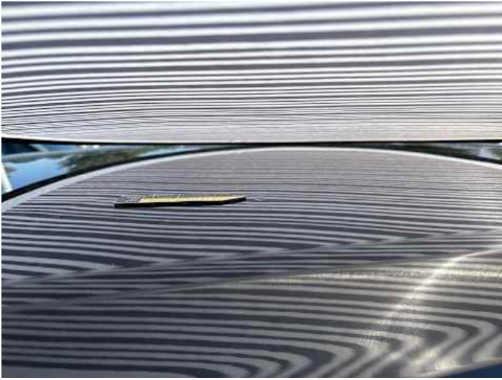
Dach (Delle, Lackschaden)
