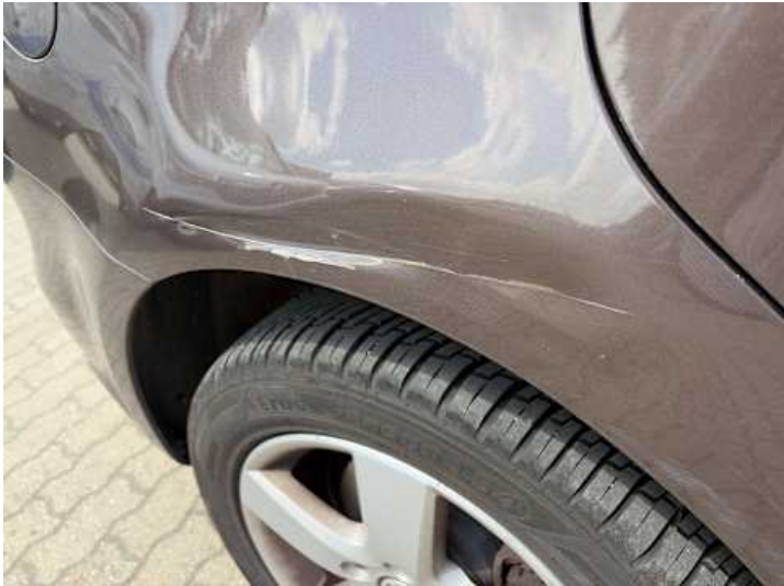
Seitenteil hinten rechts (Lackschaden, Delle)
