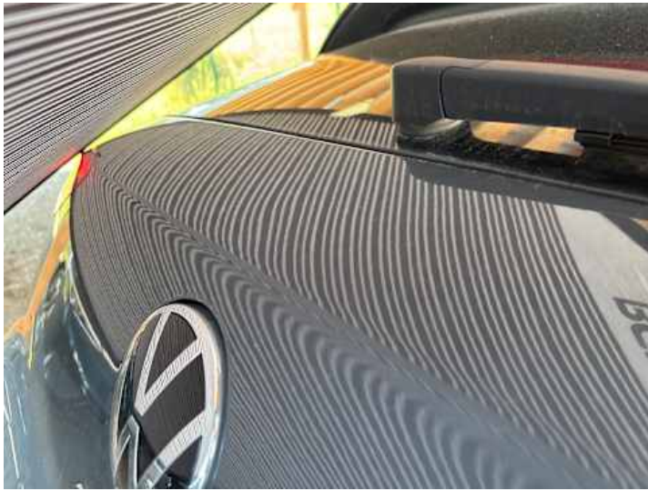
Heckklappe (Delle, Kratzer)
