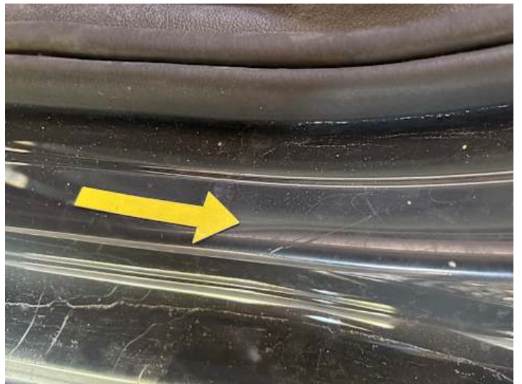
Schweller links (Kratzer)
