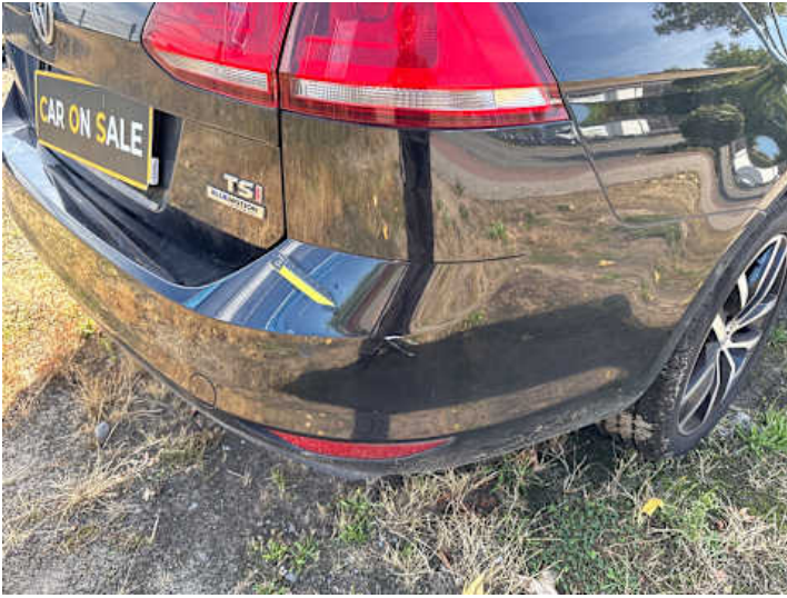
Stoßstange hinten (Lackschaden, Verformung)
