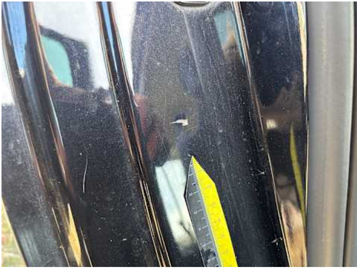
Seitenteil hinten rechts (Delle, Lackschaden)
