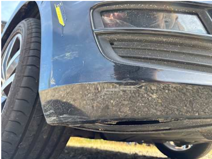
Stoßstange vorne (Lackschaden, Kratzer)
