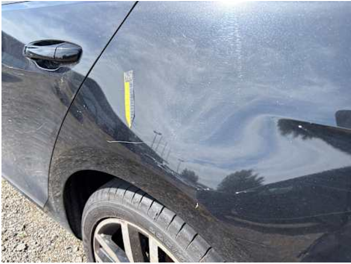
Seitenteil hinten links (Kratzer)
