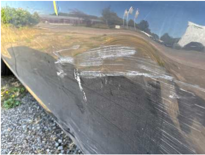
Beifahrertür (Verformung, Lackschaden, Kratzer)
