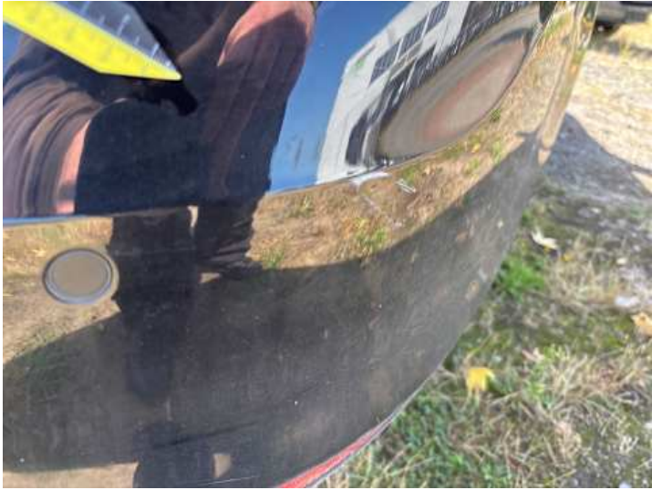
Stoßstange hinten (Lackschaden, Verformung)
