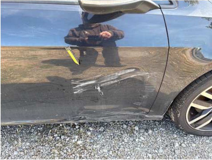
Beifahrertür (Verformung, Lackschaden, Kratzer)
