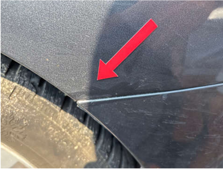
Seitenteil hinten links (Rost)
