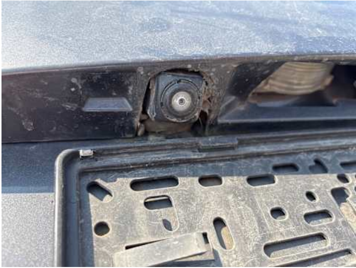
Heckklappe (Unsachgemäß instand gesetzt)
