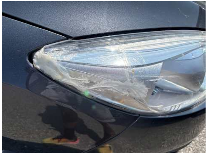
Scheinwerfer (rechts) (Riss/Bruch)
