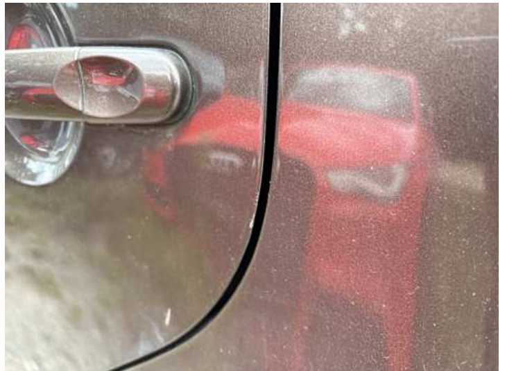
Türe hinten links (Lackschaden)
