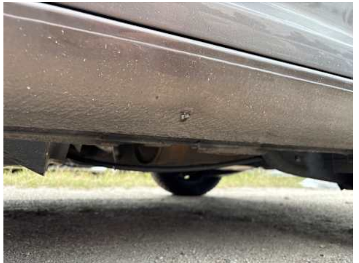
Schweller links (Verformung, Riss/Bruch)
