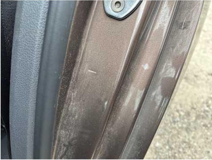
Seitenteil hinten links (Lackschaden, Delle)
