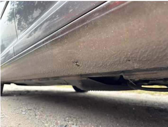
Schweller links (Verformung, Riss/Bruch)
