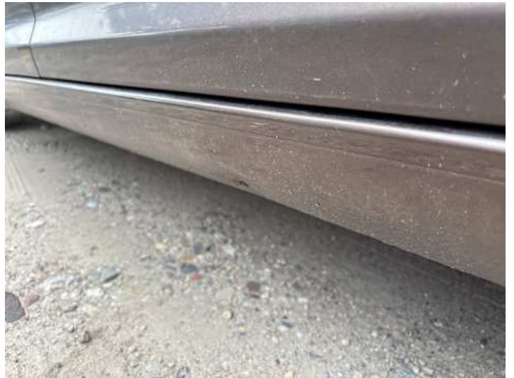
Schweller links (Verformung, Riss/Bruch)
