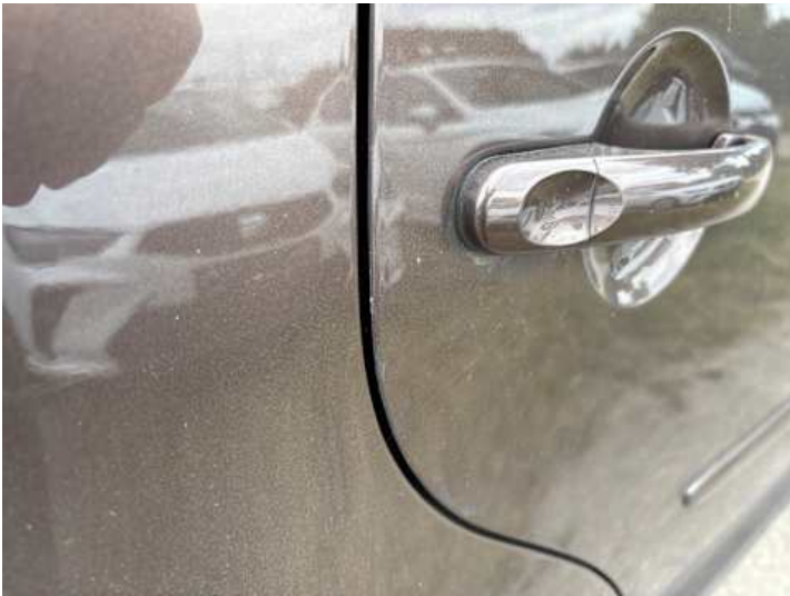
Türe hinten rechts (Lackschaden, Kratzer)
