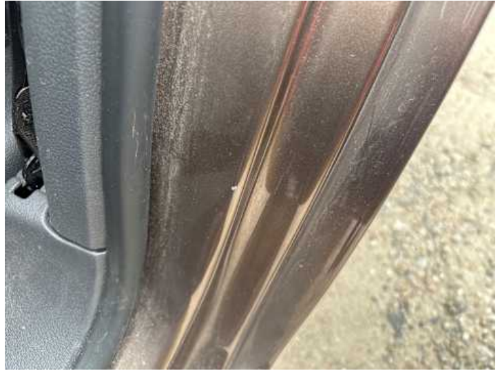
Seitenteil hinten links (Lackschaden, Delle)
