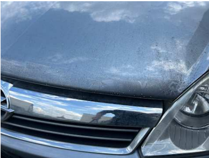
Motorhaube (Delle, Kratzer, Steinschlag)
