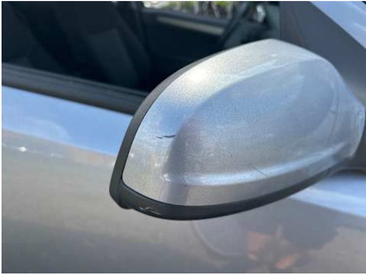
Beifahrertür (Kratzer, Lackschaden, Riss/Bruch)
