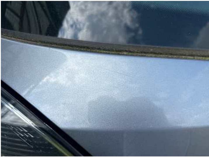
Heckklappe (Delle, Lackschaden, Kratzer)
