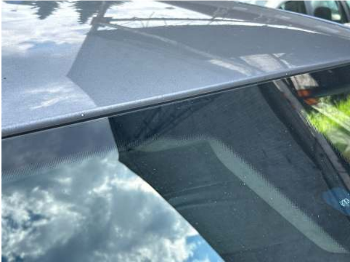
Dach (Lackschaden, Steinschlag)
