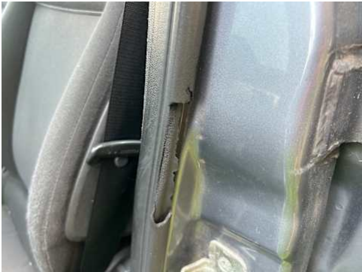
Innenraum (Diverse Schäden, Brandloch)
