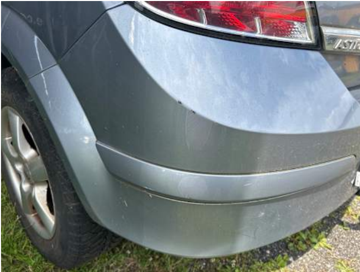
Stoßstange hinten (Kratzer, Lackschaden, Spaltmaße ungenau)
