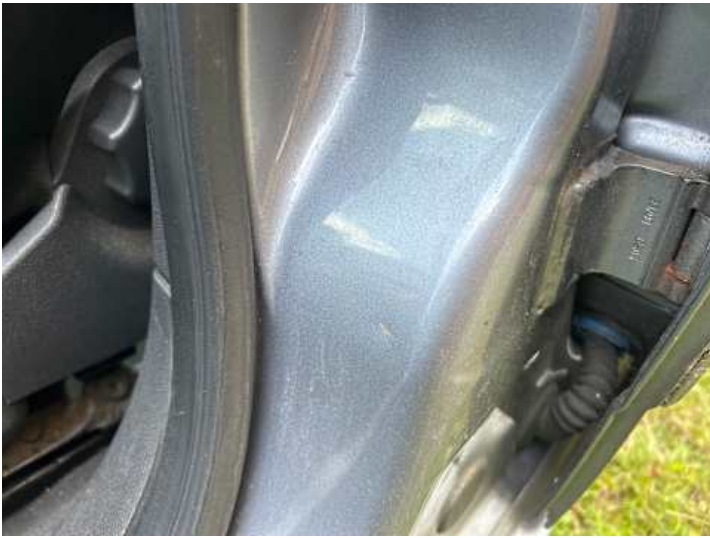
Fahrrertür (Kratzer, Delle, Lackschaden)
