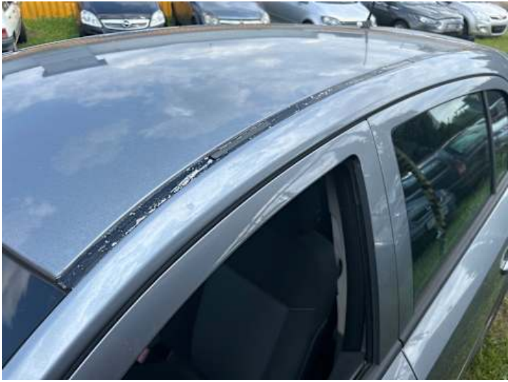
Dach (Lackschaden, Steinschlag)
