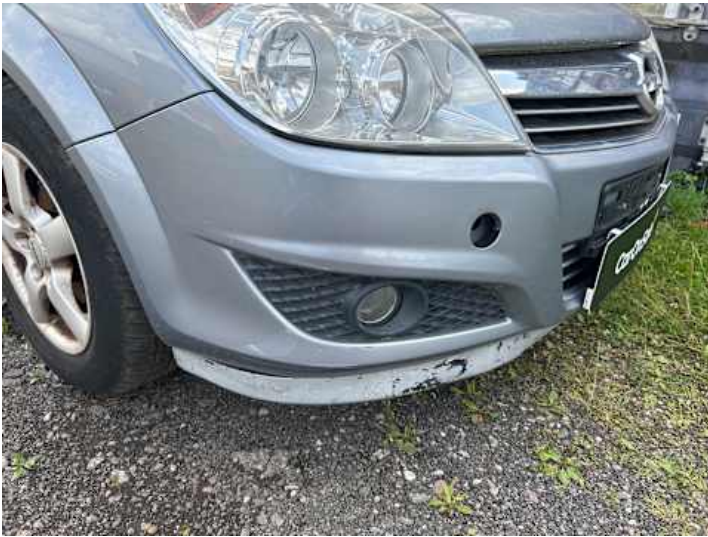
Stoßstange vorne (Riss/Bruch, Lackschaden, Kratzer)
