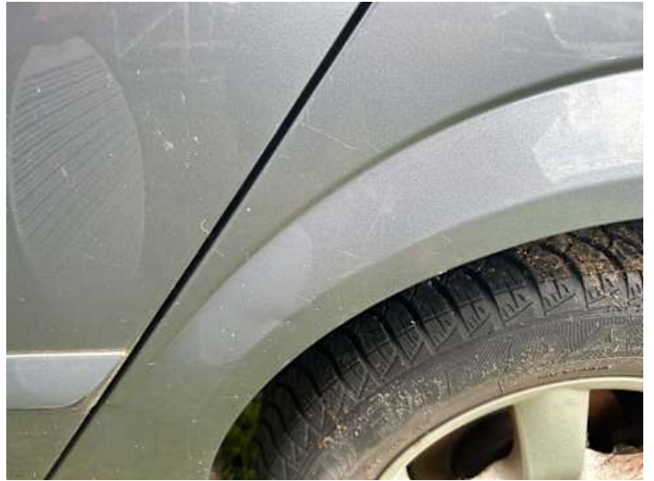
Seitenteil hinten links (Delle, Kratzer)
