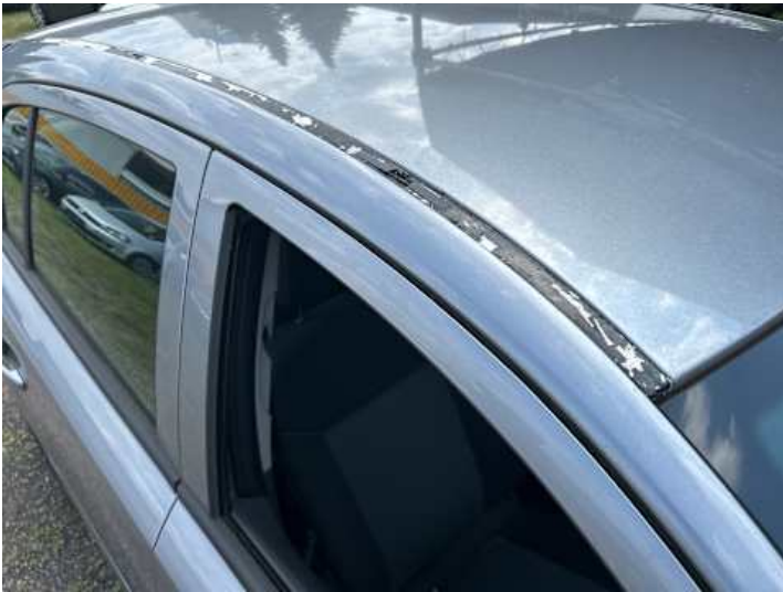
Dach (Lackschaden, Steinschlag)
