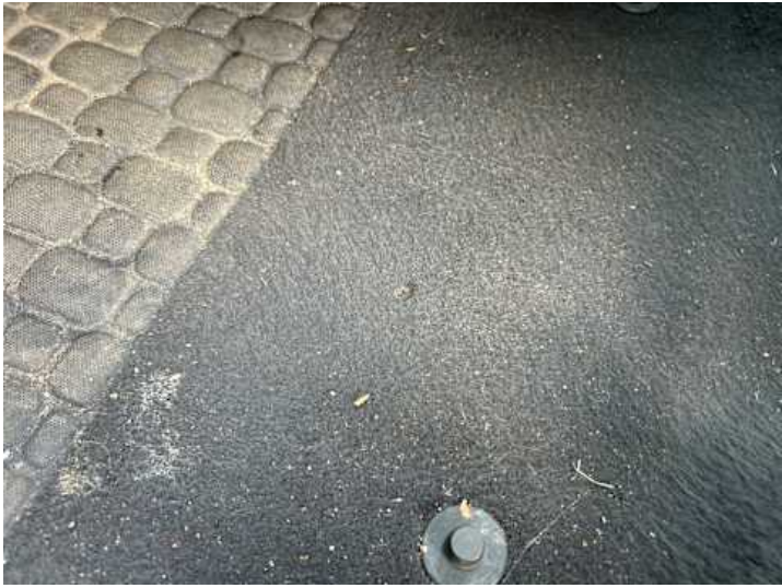
Innenraum (Diverse Schäden, Brandloch)
