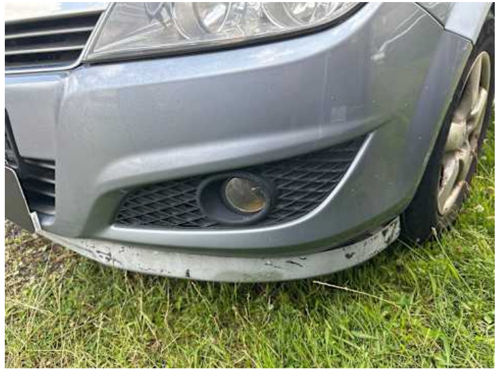
Stoßstange vorne (Riss/Bruch, Lackschaden, Kratzer)
