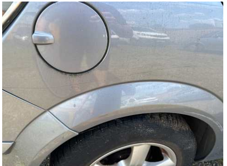
Seitenteil hinten rechts (Lackschaden, Kratzer)
