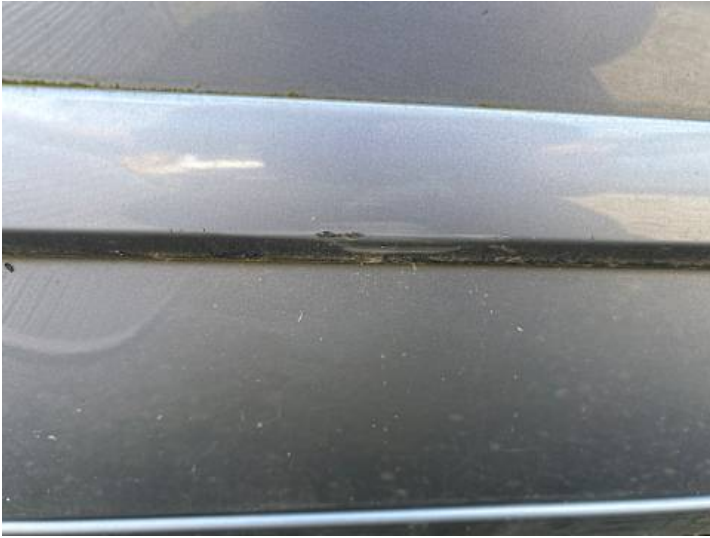
Türe hinten rechts (Kratzer, Lackschaden)
