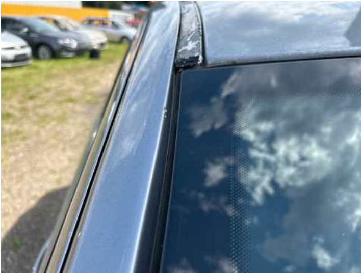
Dach (Lackschaden, Steinschlag)
