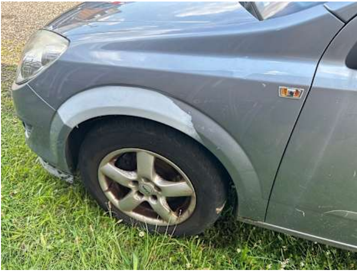
Kotflügel vorne links (Lackschaden, Unsachgemäß instand gesetzt)
