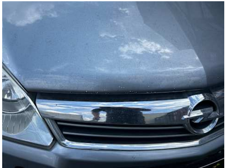
Motorhaube (Delle, Kratzer, Steinschlag)
