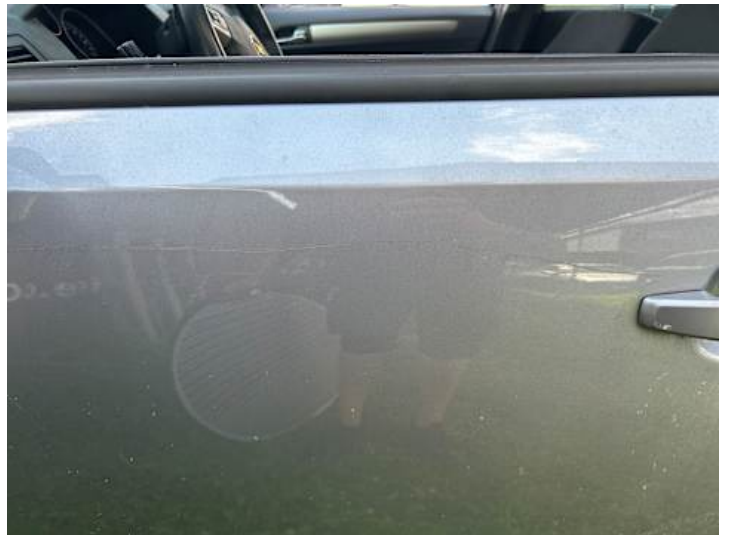
Fahrtür (Kratzer, Delle, Lackschaden)
