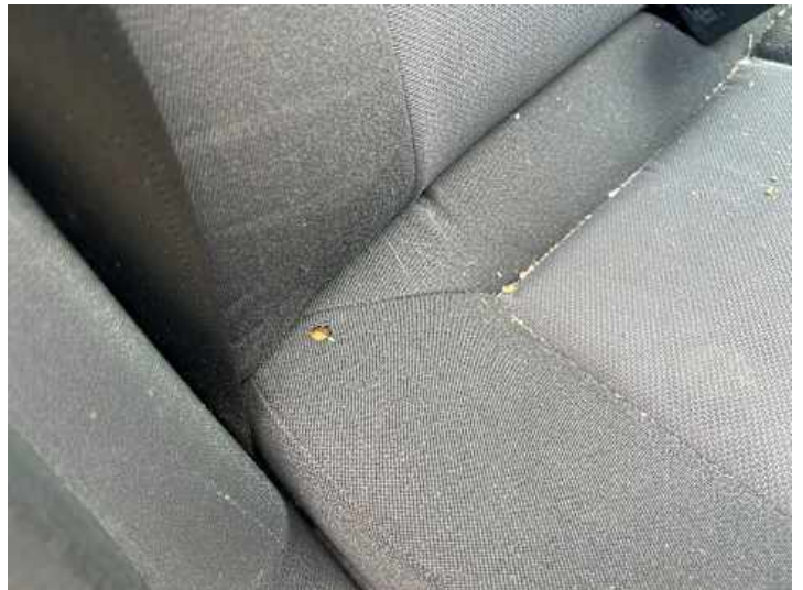
Innenraum (Diverse Schäden, Brandloch)
