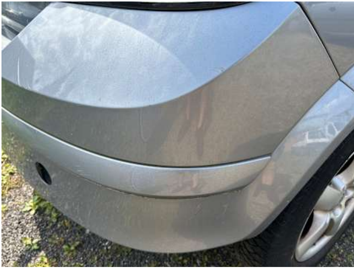
Stoßstange hinten (Kratzer, Lackschaden, Spaltmaße ungenau)
