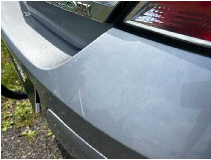
Stoßstange hinten (Kratzer, Lackschaden, Spaltmaße ungenau)
