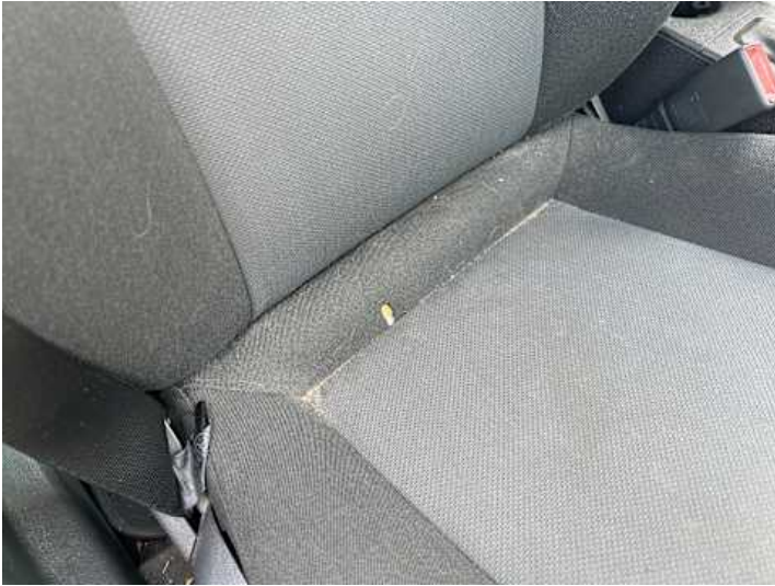
Innenraum (Diverse Schäden, Brandloch)
