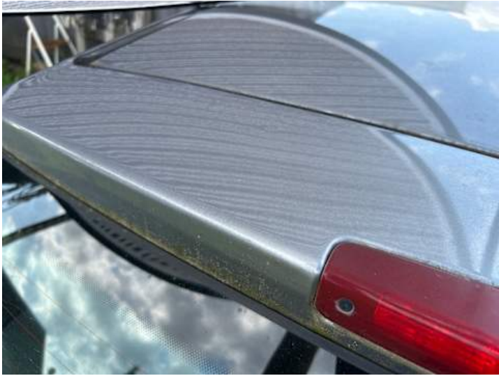
Heckklappe (Delle, Lackschaden, Kratzer)
