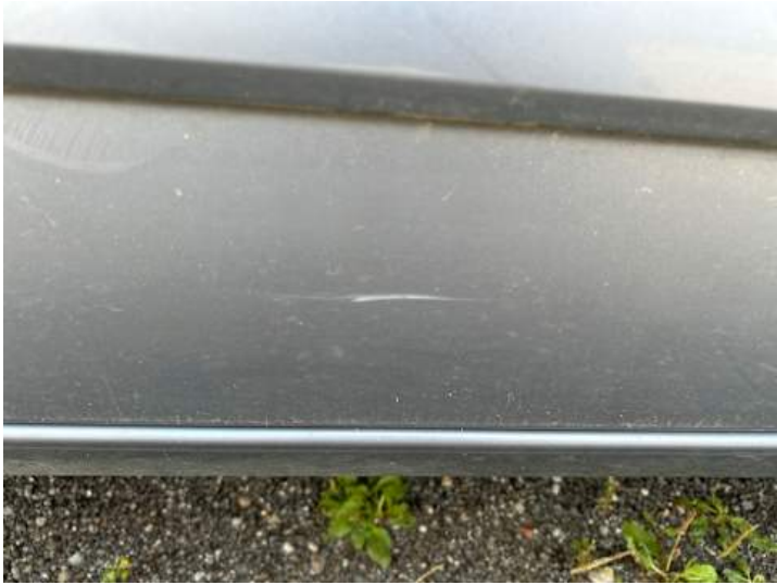
Beifahrertür (Kratzer, Lackschaden, Riss/Bruch)
