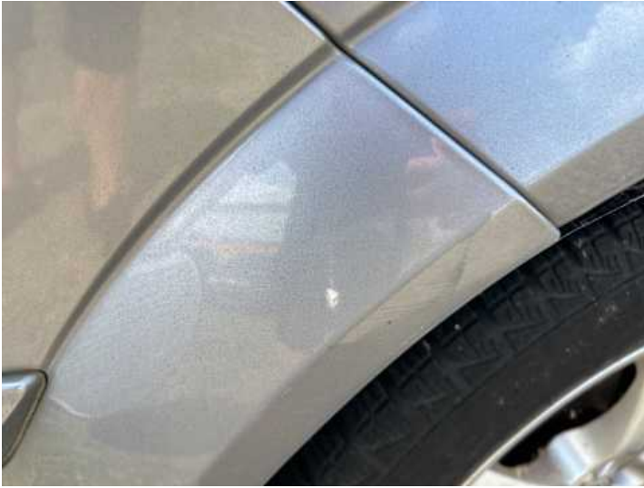
Stoßstange hinten (Kratzer, Lackschaden, Spaltmaße ungenau)
