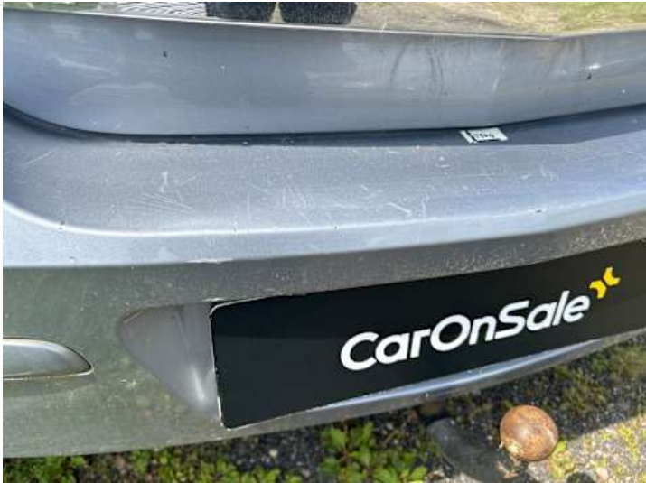
Stoßstange hinten (Kratzer, Lackschaden, Spaltmaße ungenau)
