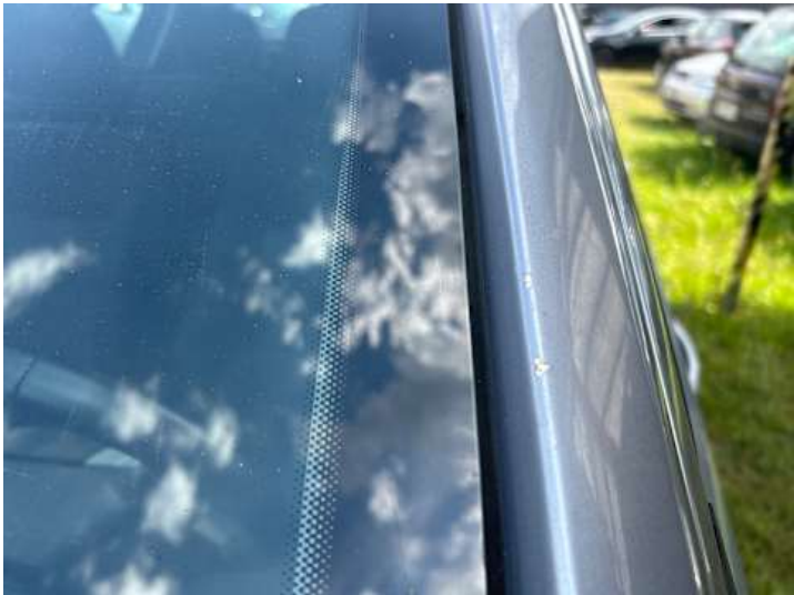
Dach (Lackschaden, Steinschlag)
