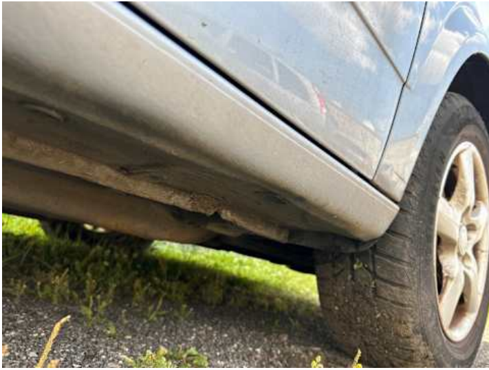
Schweller rechts (Verformung, Kratzer)
