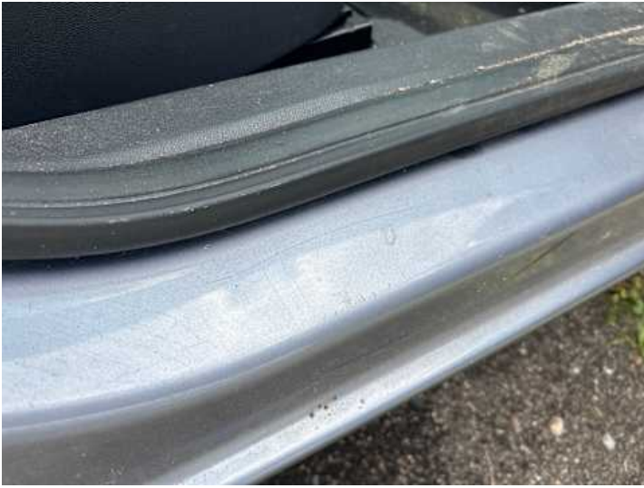
Schweller rechts (Verformung, Kratzer)
