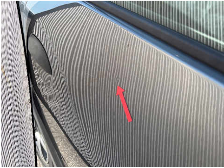
Türe hinten rechts (Lackschaden, Delle)
