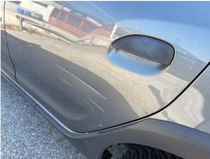
Türe hinten links (Kratzer, Verformung)
