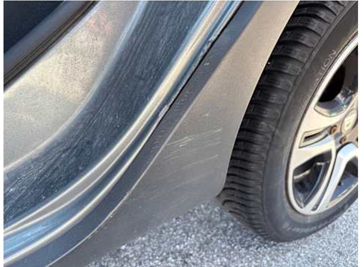
Schweller links (Kratzer, Lackschaden)
