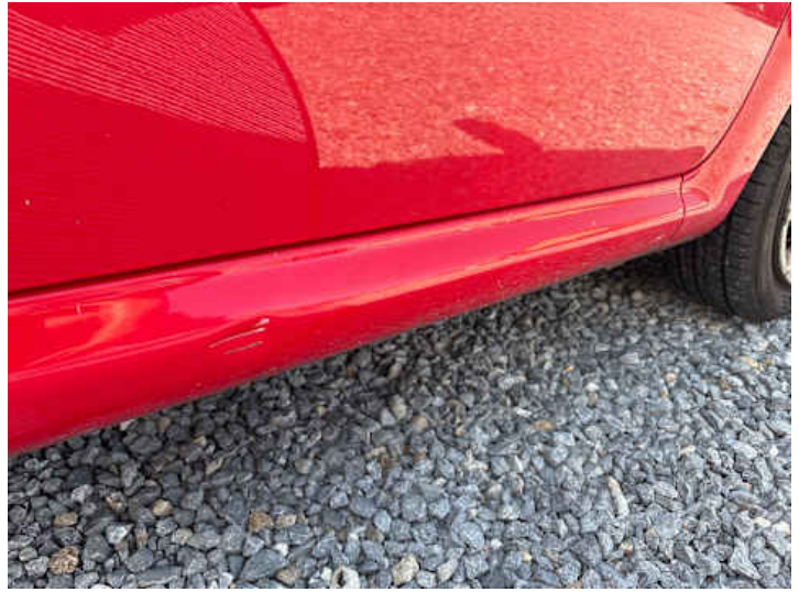
Schweller rechts (Kratzer, Lackschaden, Delle)
