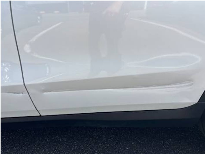
Türe hinten links (Kratzer, Verformung)
