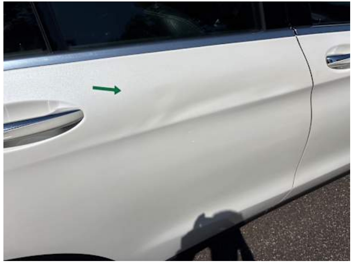
Türe hinten rechts (Verformung)
