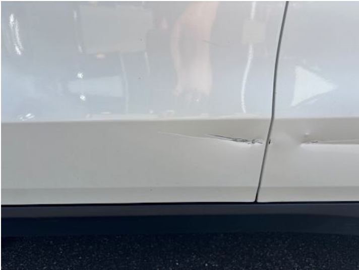
Fahrtür (Kratzer, Verformung)
