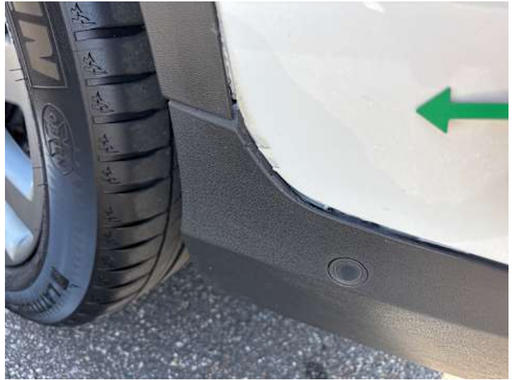
Stoßstange hinten (Spaltmaße ungenau, Riss/Bruch)
