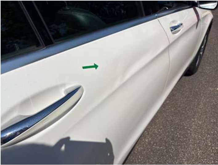
Türe hinten rechts (Verformung)
