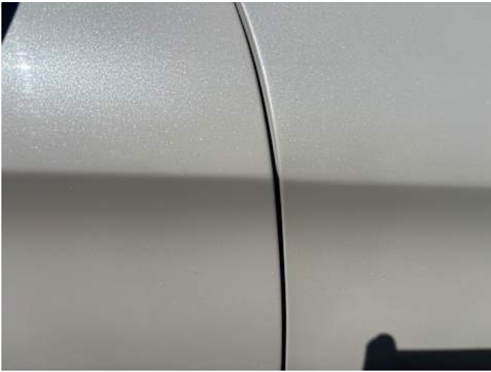
Beifahrertür (Anderer Schaden, Lackschaden): Lackunterschied
