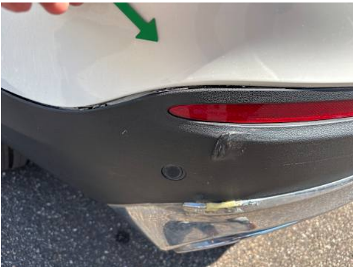
Stoßstange hinten (Spaltmaße ungenau, Riss/Bruch)
