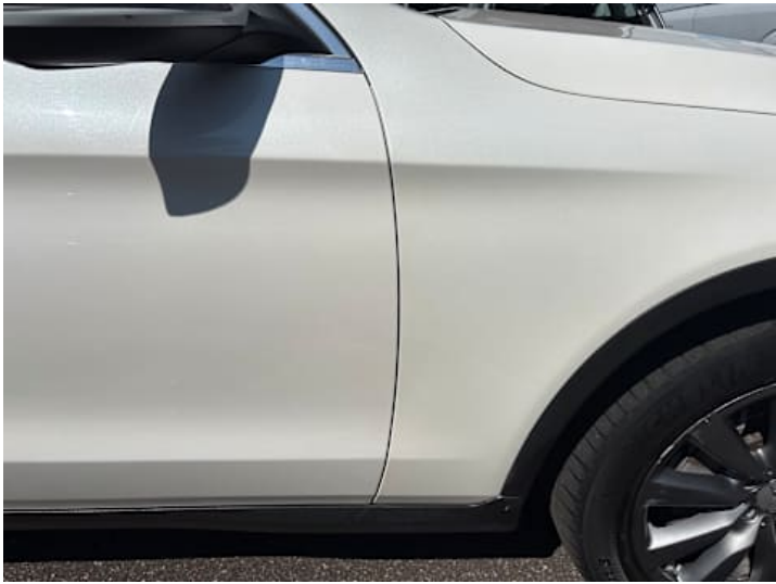
Beifahrertür (Anderer Schaden, Lackschaden): Lackunterschied
