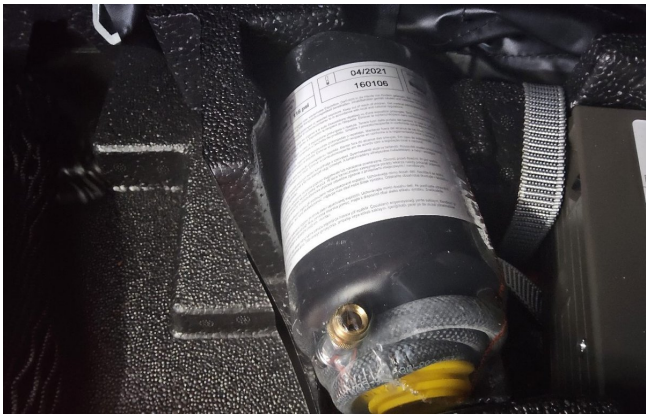
Reifendichtmittel verschlissen (DEKRA)
