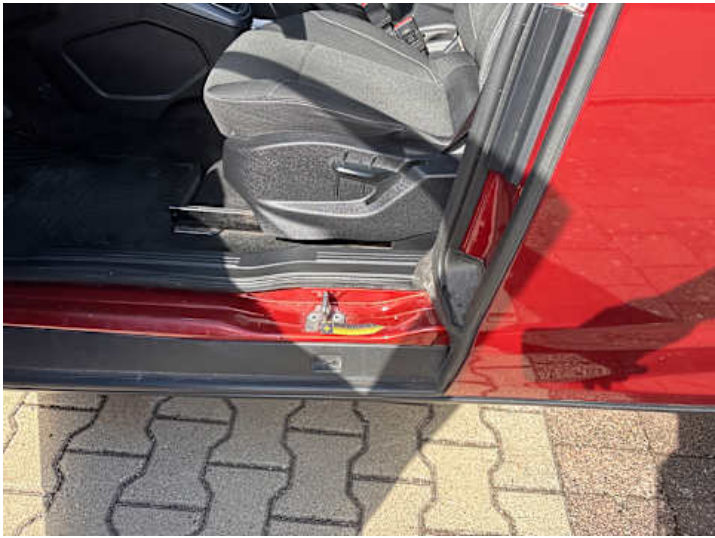
Schweller links (Kratzer)
