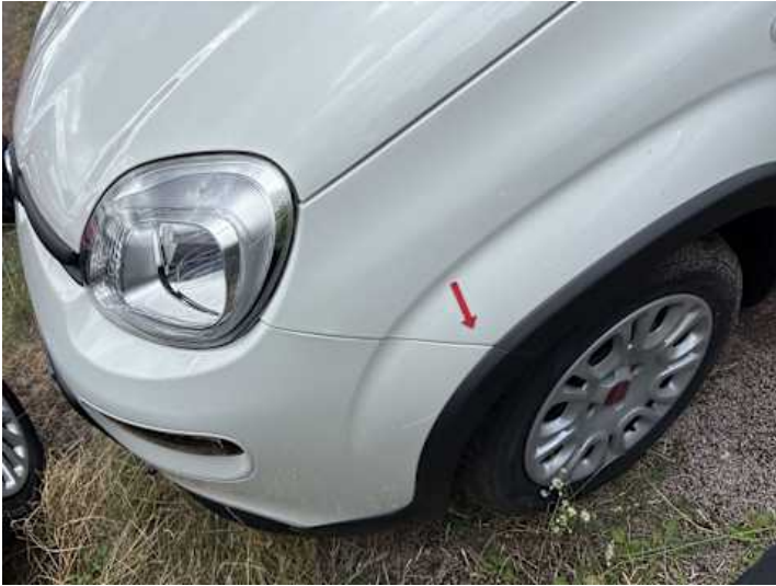
Stoßstange vorne (Spaltmaße ungenau)
