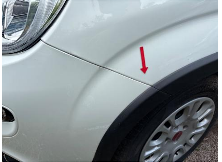
Stoßstange vorne (Spaltmaße ungenau)
