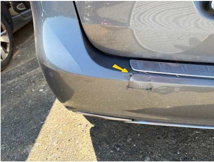
Stoßstange hinten (Riss/Bruch)
