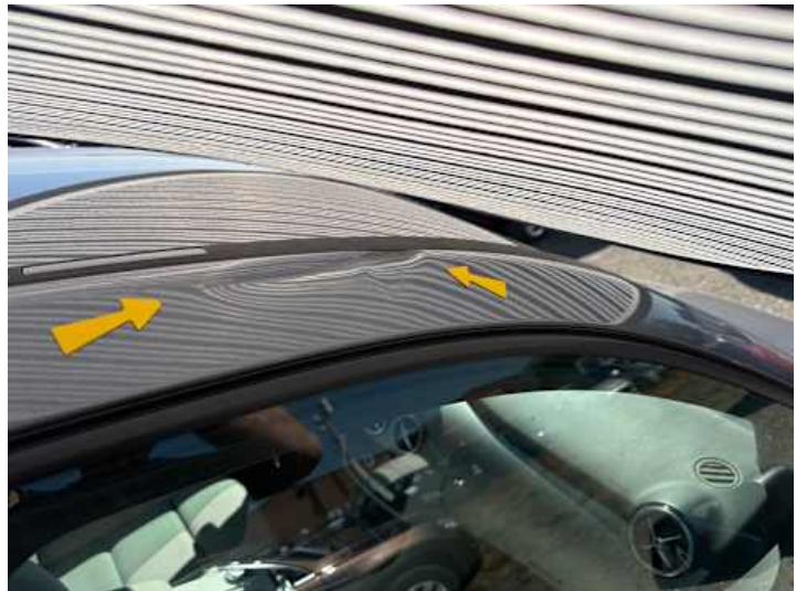
Dach (Delle, Verformung)
