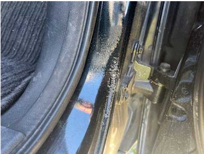
Schweller rechts (Unsachgemäß instand gesetzt, Lackschaden)
