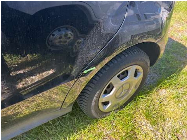
Seitenteil hinten links (Lackschaden)
