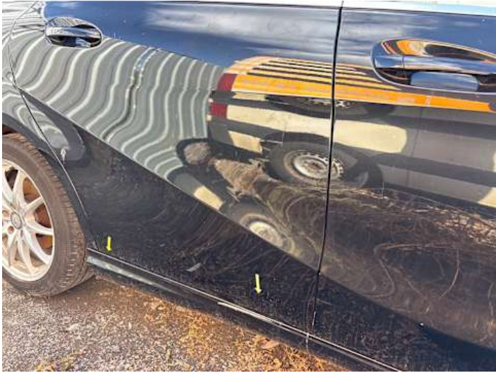
Schweller rechts (Kratzer, Lackschaden)
