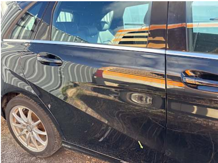
Türe hinten rechts (Kratzer, Delle)
