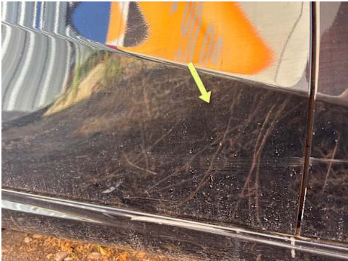
Türe hinten rechts (Kratzer, Delle)
