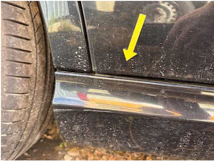
Schweller rechts (Kratzer, Lackschaden)
