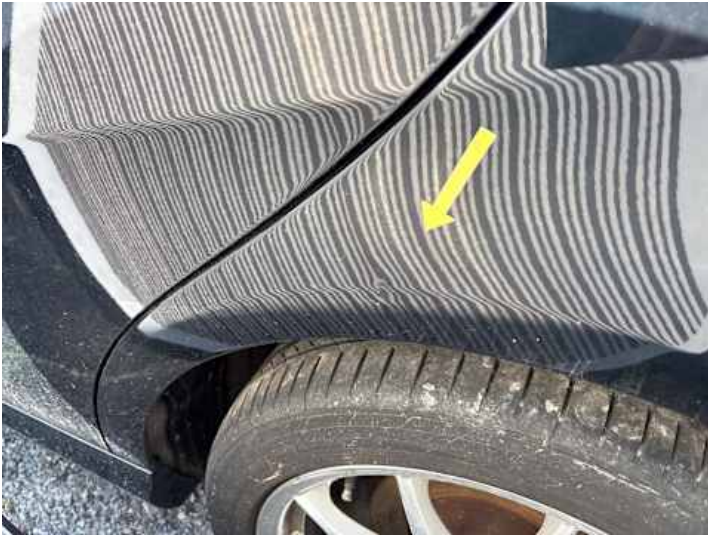
Seitenteil hinten links (Delle)
