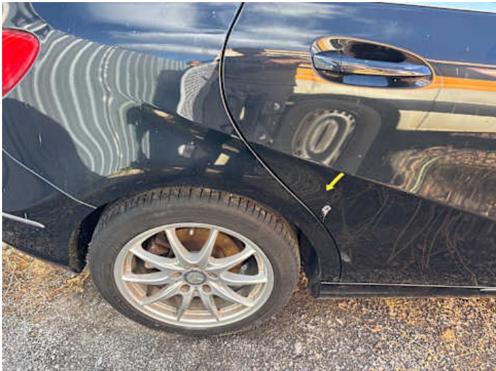
Seitenteil hinten rechts (Delle)
