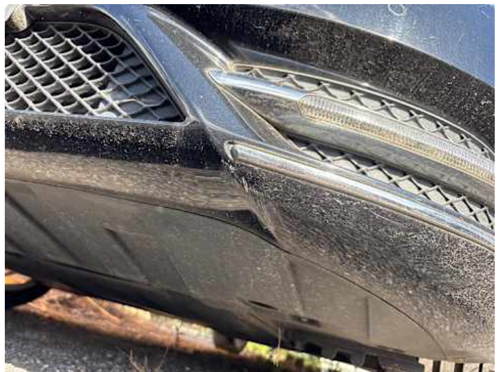
Stoßstange vorne (Kratzer, Lackschaden)
