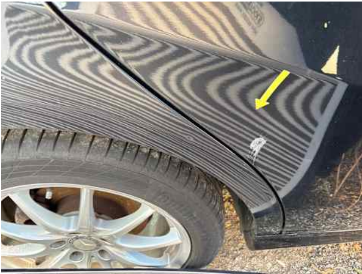
Seitenteil hinten rechts (Delle)
