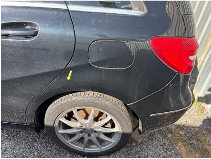
Seitenteil hinten links (Delle)
