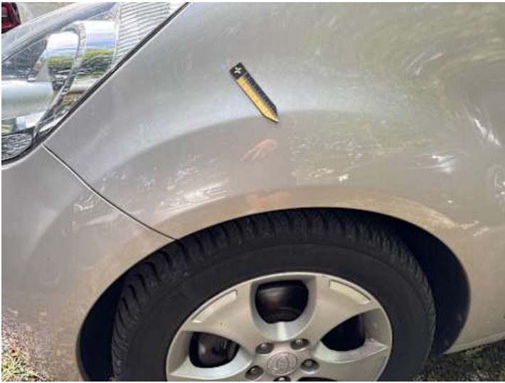
Kotflügel vorne links (Kratzer, Lackschaden)
