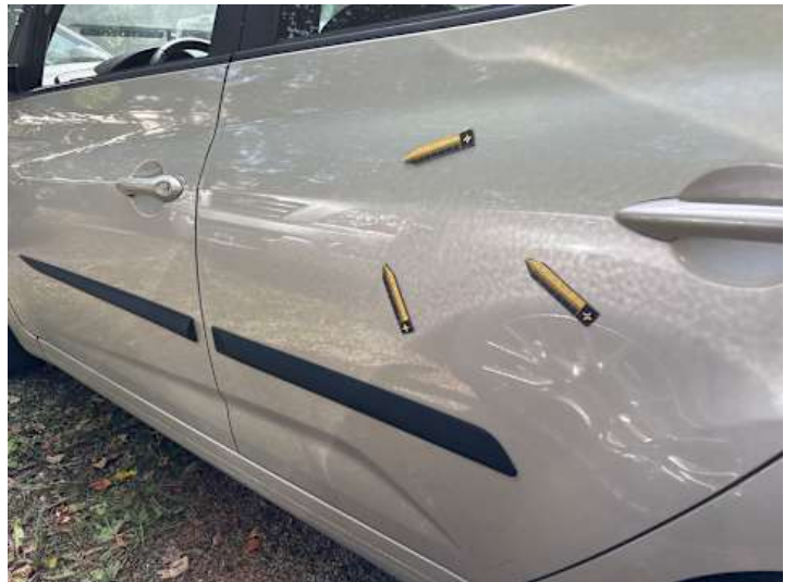
Türe hinten links (Lackschaden, Delle, Kratzer)
