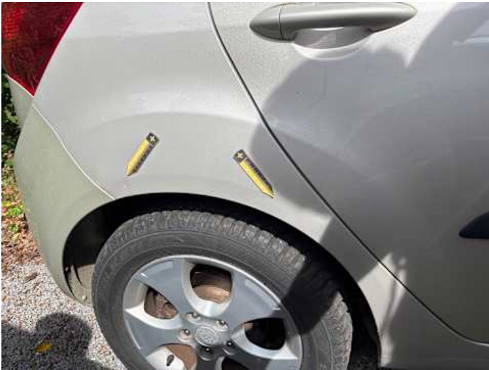
Seitenteil hinten rechts (Delle, Kratzer, Lackschaden)
