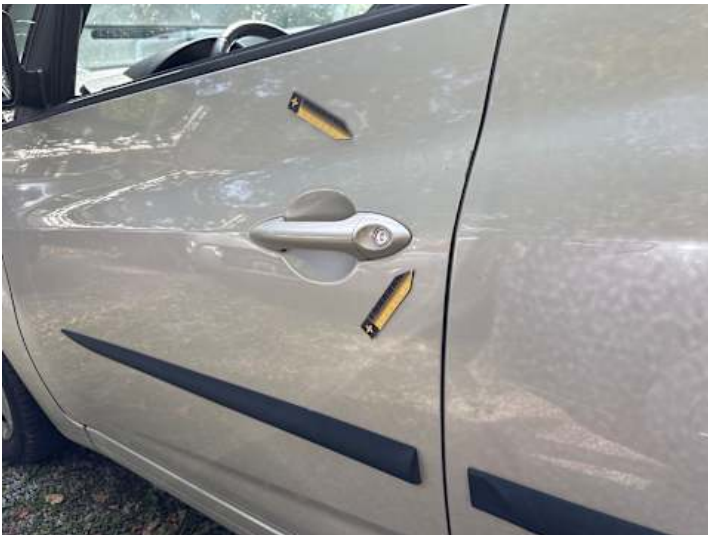
Fahrtür (Kratzer, Lackschaden, Delle)
