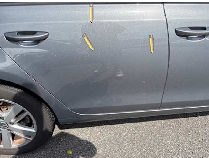
Türe hinten rechts (Lackschaden, Delle)
