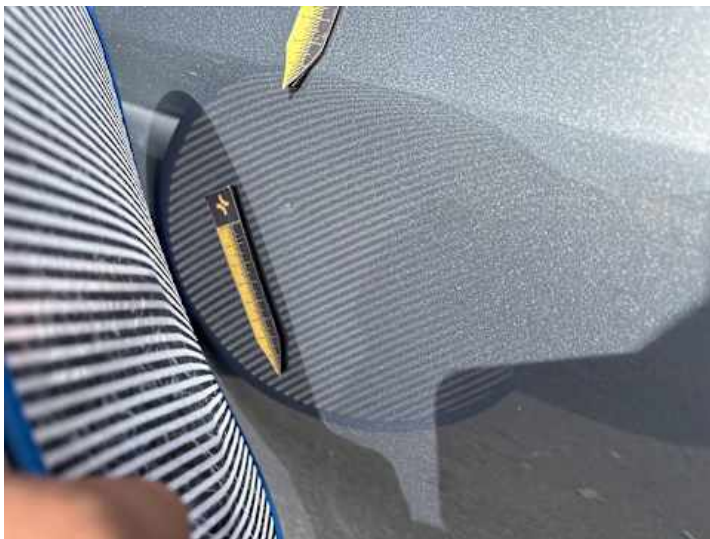
Türe hinten rechts (Lackschaden, Delle)
