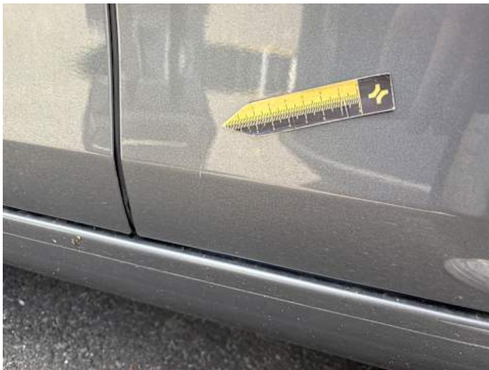
Türe hinten links (Kratzer)
