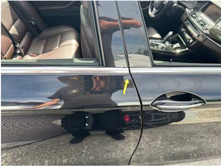
Türe hinten rechts (Rost)
