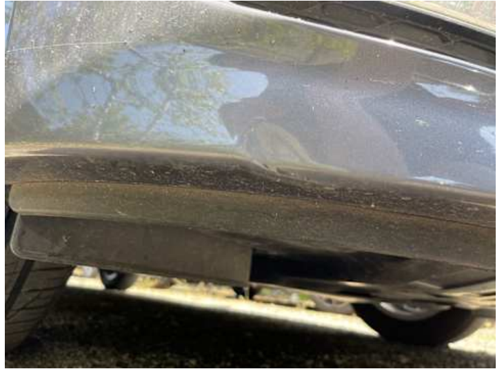
Stoßstange vorne (Kratzer, Lackschaden, Verformung)
