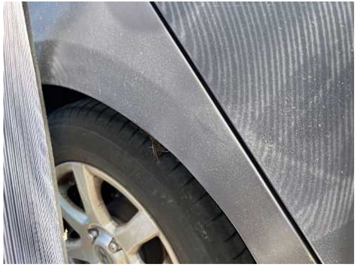
Seitenteil hinten rechts (Lackschaden, Unsachgemäß instand gesetzt, Ausgeblichen/Matt)
