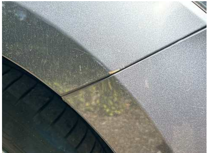
Kotflügel vorne rechts (Lackschaden, Rost)
