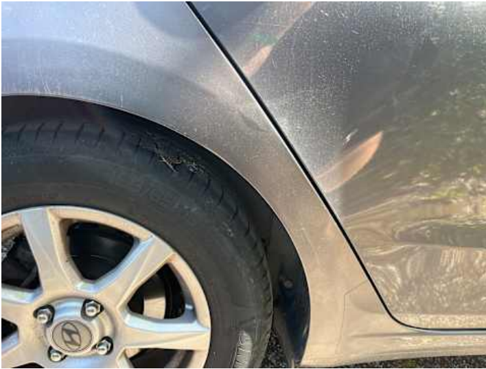
Seitenteil hinten rechts (Lackschaden, Unsachgemäß instand gesetzt, Ausgeblichen/Matt)
