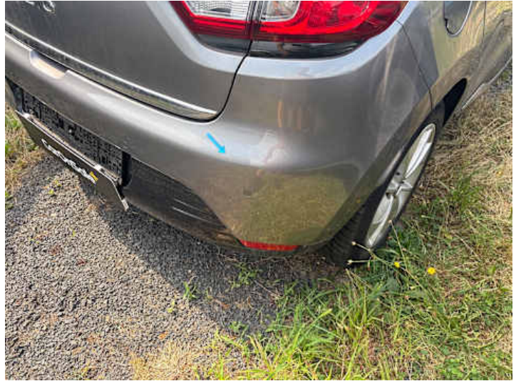
Stoßstange hinten (Lackschaden)
