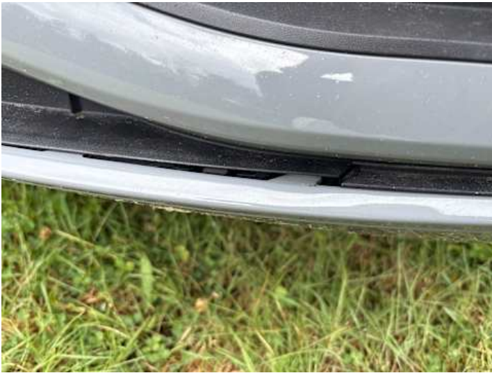
Stoßstange vorne (Spaltmaße ungenau)
