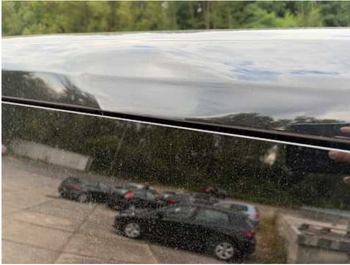
Dach (Lackschaden, Kratzer, Verformung)
