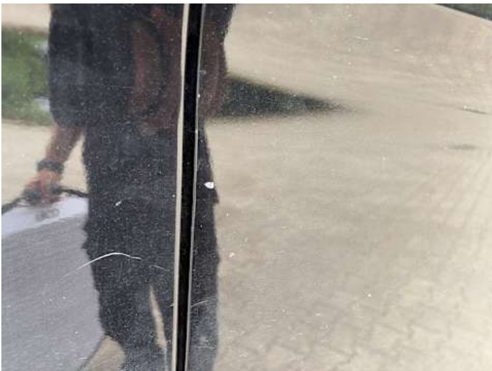
Beifahrtür (Lackschaden, Kratzer)
