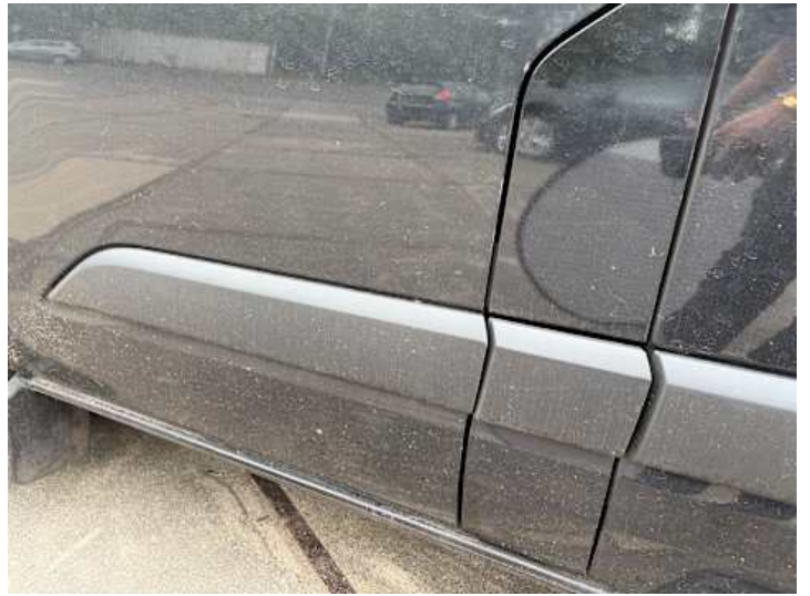
Fahrtür (Lackschaden, Kratzer)
