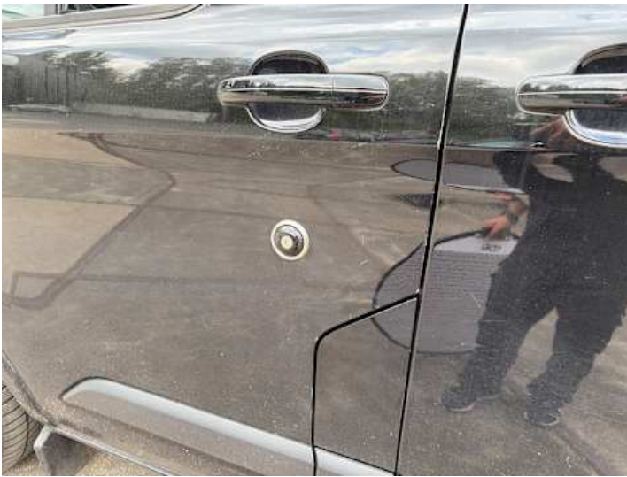
Fahrtür (Lackschaden, Kratzer)
