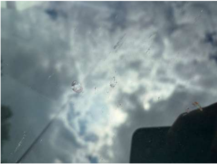
Windschutzscheibe (Steinschlag, Riss/Bruch)
