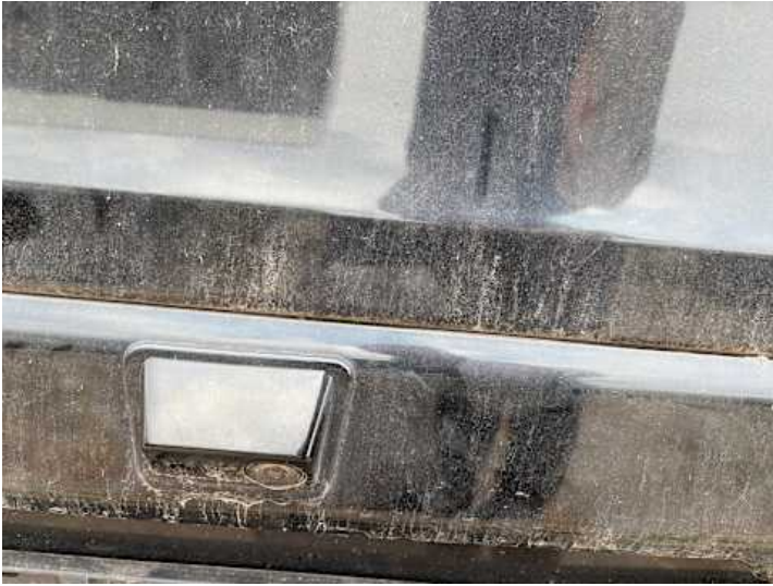
Heckklappe (Lackschaden, Kratzer)
