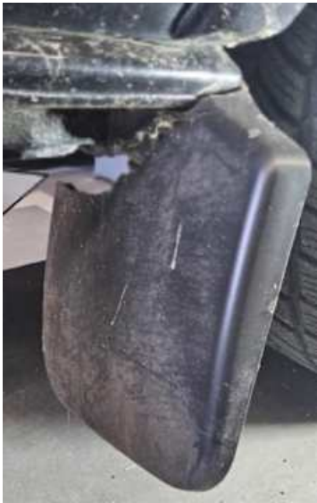
Schweller rechts (Riss/Bruch)
