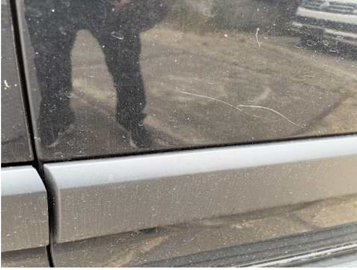
Türe hinten links (Delle)
