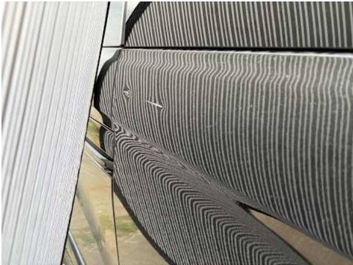
Türe hinten rechts (Delle)
