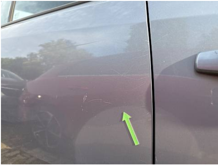
Türe hinten rechts (Kratzer)
