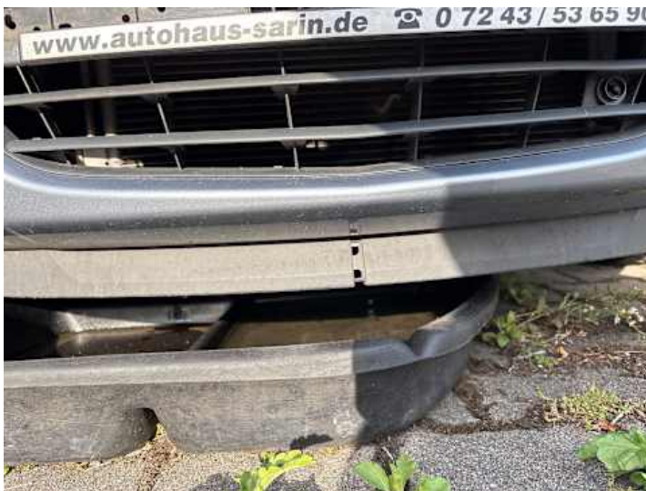
Stoßstange vorne (Spaltmaße ungenau)
