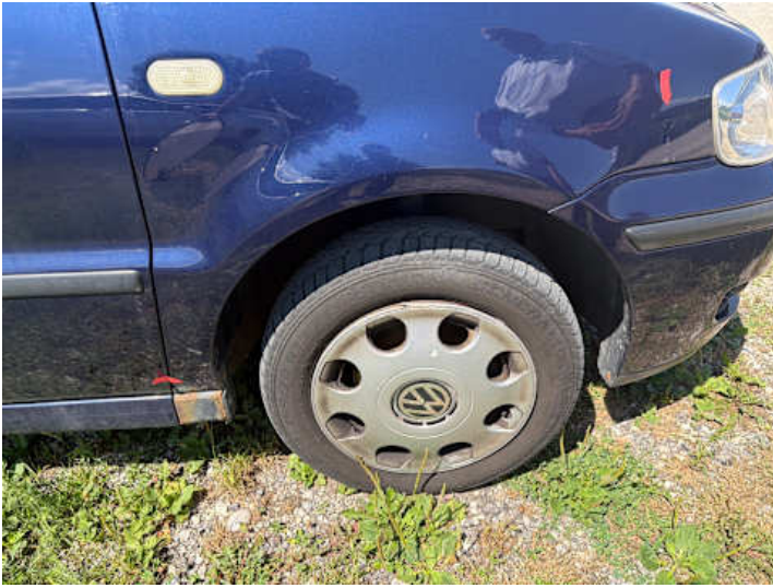
Kotflügel vorne rechts (Rost)
