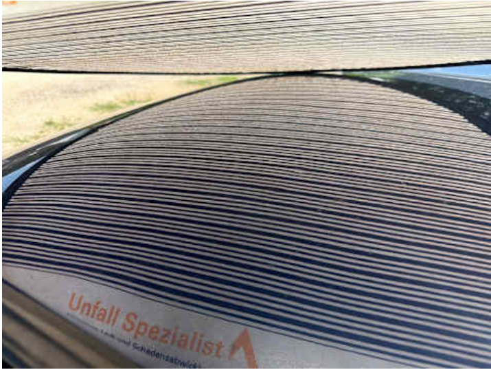
Dach (Anderer Schaden): Leichter Hagelschaden
