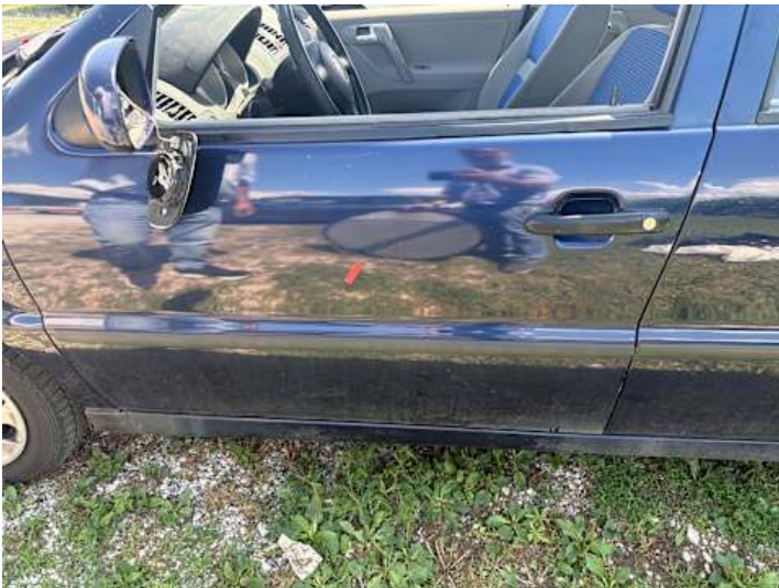
Fahrtür (Unsachgemäß instand gesetzt)
