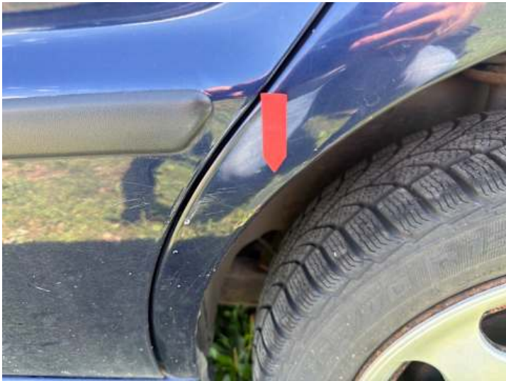
Seitenteil hinten links (Kratzer)
