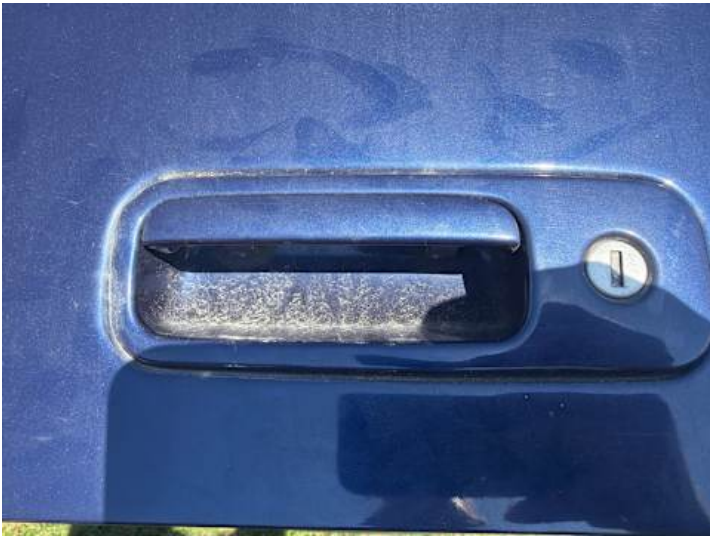
Heckklappe (Anderer Schaden): Schliesszylinder defekt
