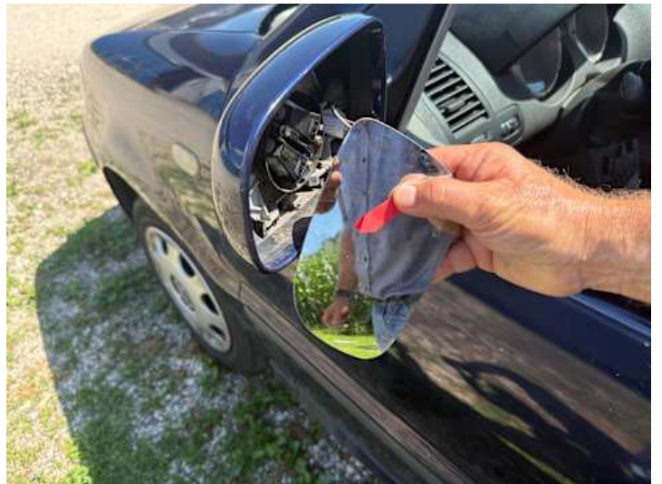
Fahrtür (Anderer Schaden): Rückspiegelglas gebrochen
