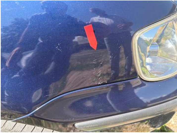
Kotflügel vorne rechts (Kratzer)
