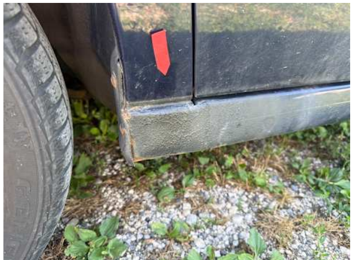
Schweller links (Rost)
