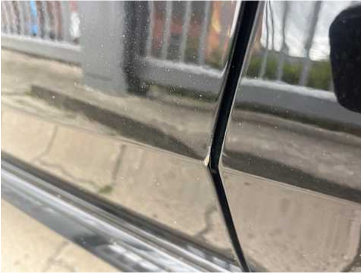
Fahrertür (Lackschaden, Rost)
