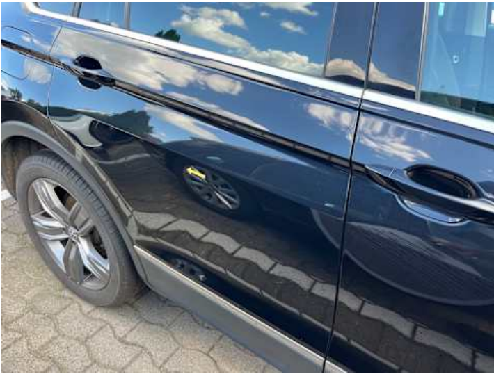
Türe hinten rechts (Delle)
