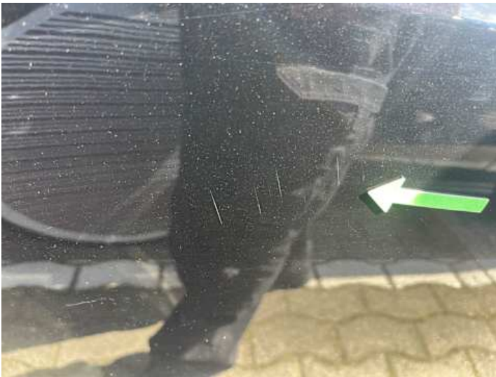
Beifahrertür (Kratzer, Lackschaden)
