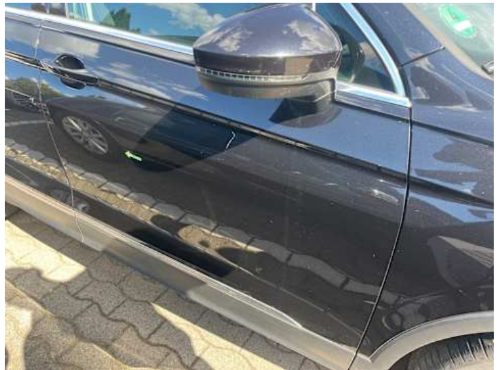
Beifahrertür (Kratzer, Lackschaden)
