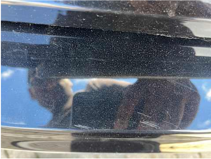
Stoßstange hinten (Kratzer, Lackschaden)
