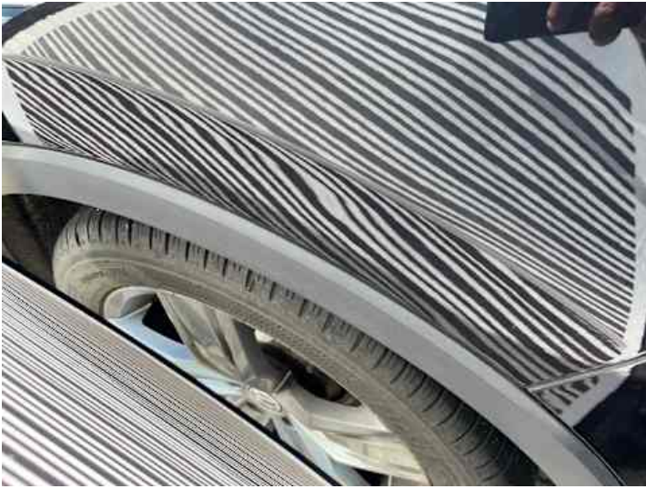
Seitenteil hinten links (Delle)
