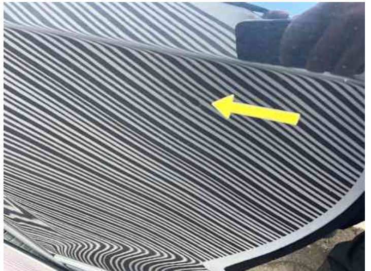
Türe hinten rechts (Delle)
