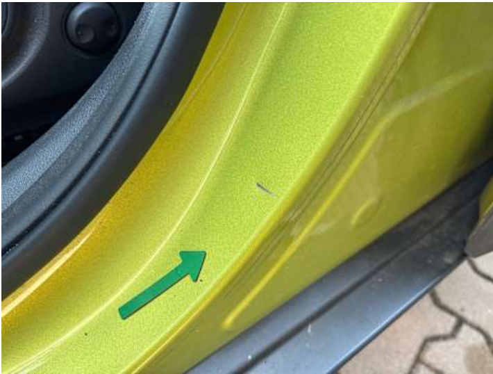
Schweller links (Kratzer)
