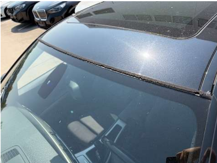
Windschutzscheibe (Anderer Schaden, Riss/Bruch): Dichtung porös;
