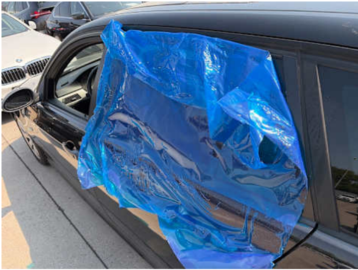
Türe hinten links (Riss/Bruch, Anderer Schaden): Fensterheber ohne Funktion!
