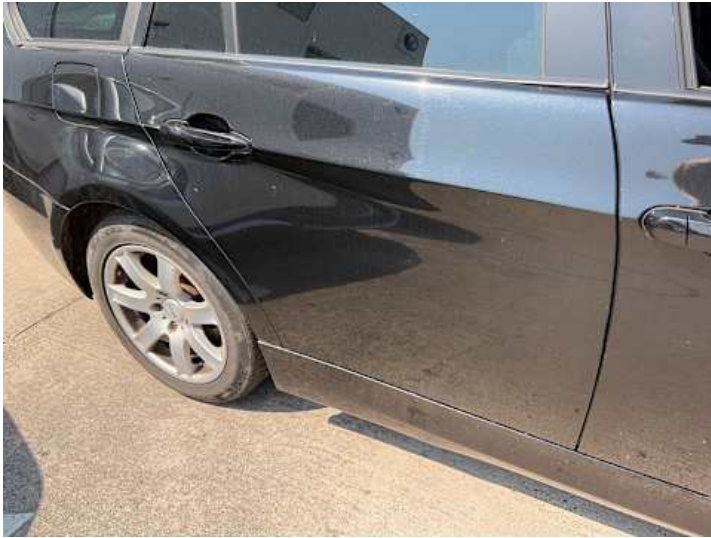
Türe hinten rechts (Kratzer, Delle)
