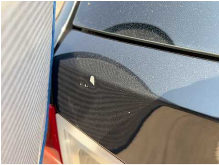
Heckklappe (Kratzer, Delle)
