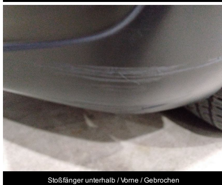
Stoßfänger unterhalb / Vorne / Gebrochen
