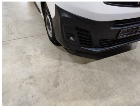
Stoßfänger unterhalb / Vorne / Gebrochen
