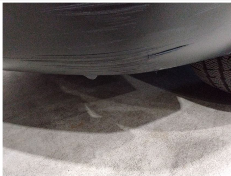
Stoßfänger unterhalb / Vorne / Gebrochen
