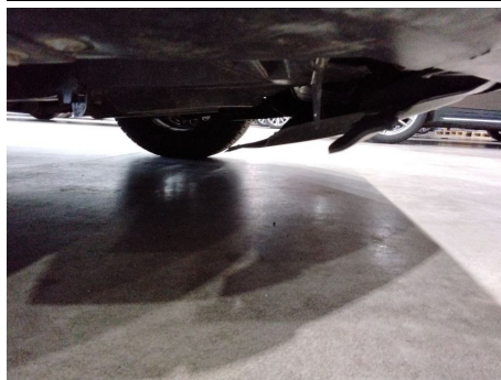
Unterfahrschutz / Vorne / Gebrochen
