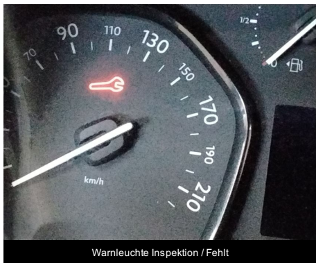
Warnleuchte Inspektion / Fehlt
