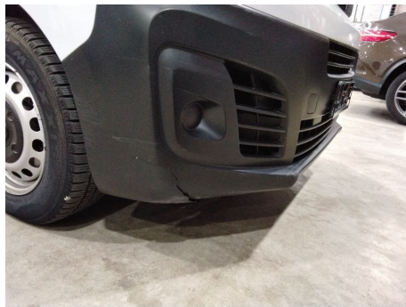
Unterfahrschutz / Vorne / Gebrochen
