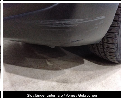
Stoßfänger unterhalb / Vorne / Gebrochen
