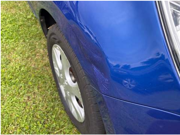
Kotflügel vorne rechts (Verformung, Kratzer)
