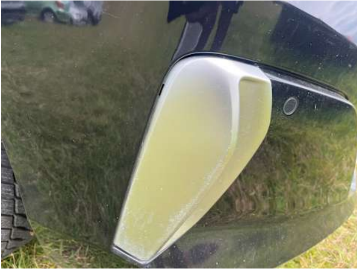
Stoßstange vorne (Kratzer, Spaltmaße ungenau)
