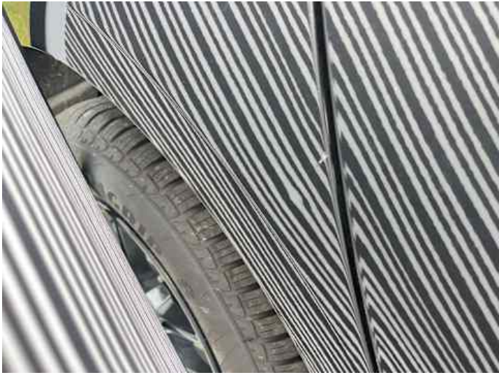
Seitenteil hinten rechts (Delle)
