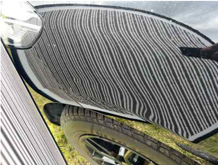
Kotflügel vorne links (Delle)
