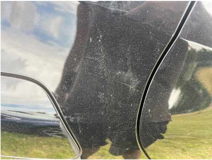
Seitenteil hinten rechts (Kratzer, Lackschaden)
