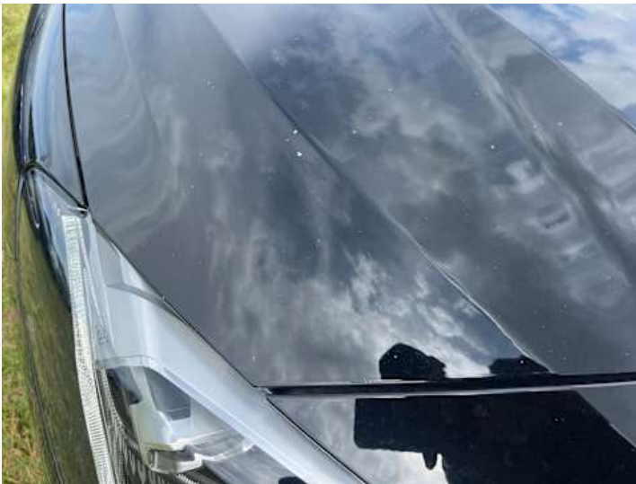
Motorhaube (Lackschaden, Steinschlag)
