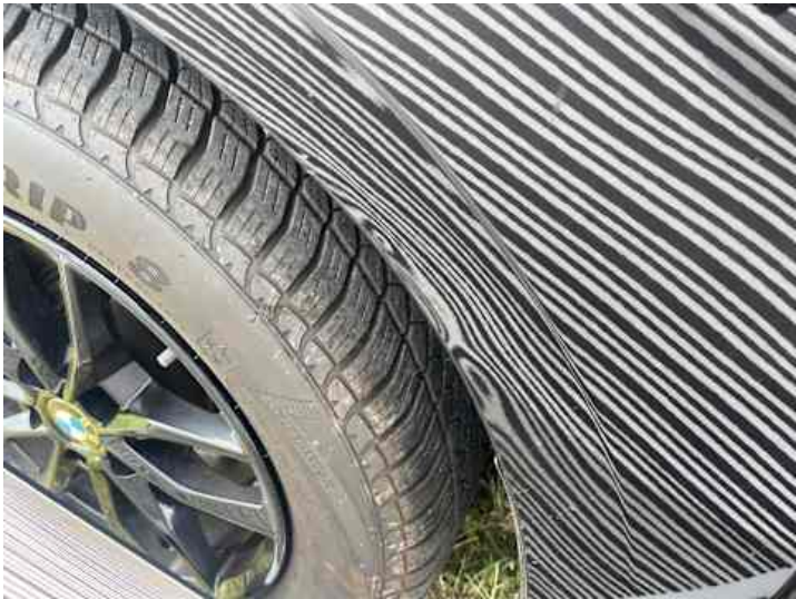
Kotflügel vorne links (Delle)
