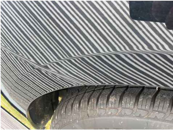
Seitenteil hinten rechts (Verformung)
