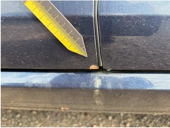
Fahrtür (Rost, Lackschaden)
