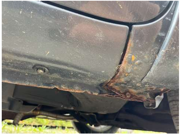
Schweller rechts (Rost, Lackschaden)
