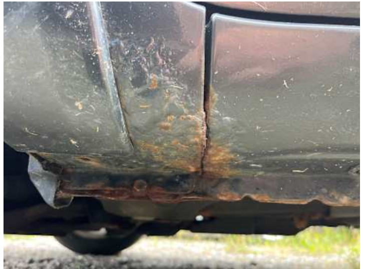
Kotflügel vorne links (Lackschaden, Rost)
