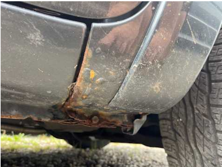
Kotflügel vorne rechts (Rost, Lackschaden)
