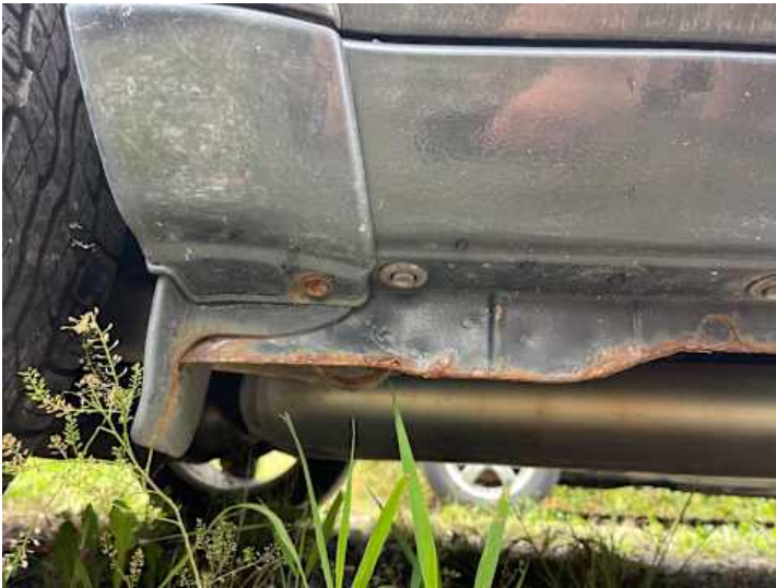
Schweller rechts (Rost, Lackschaden)
