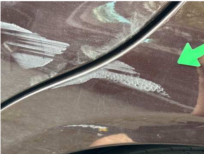
Seitenteil hinten links (Kratzer, Lackschaden, Verformung)
