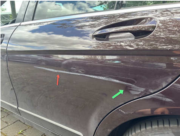
Türe hinten links (Kratzer, Lackschaden, Verformung)
