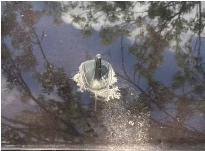
Dach (Lackschaden, Rost)
