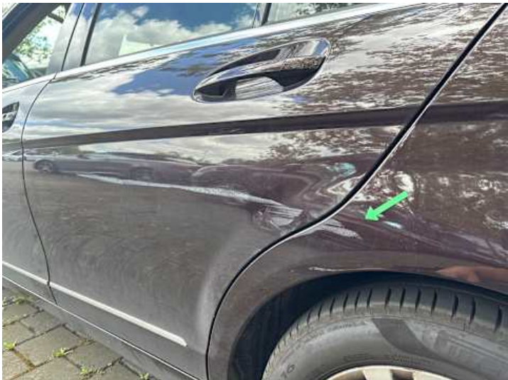
Seitenteil hinten links (Kratzer, Lackschaden, Verformung)
