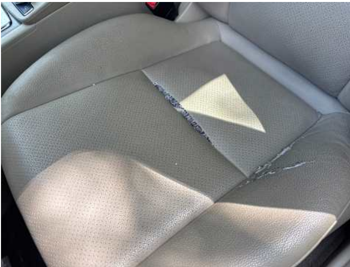
Innenraum (Verschleiß, Kratzer, Riss/Bruch)
