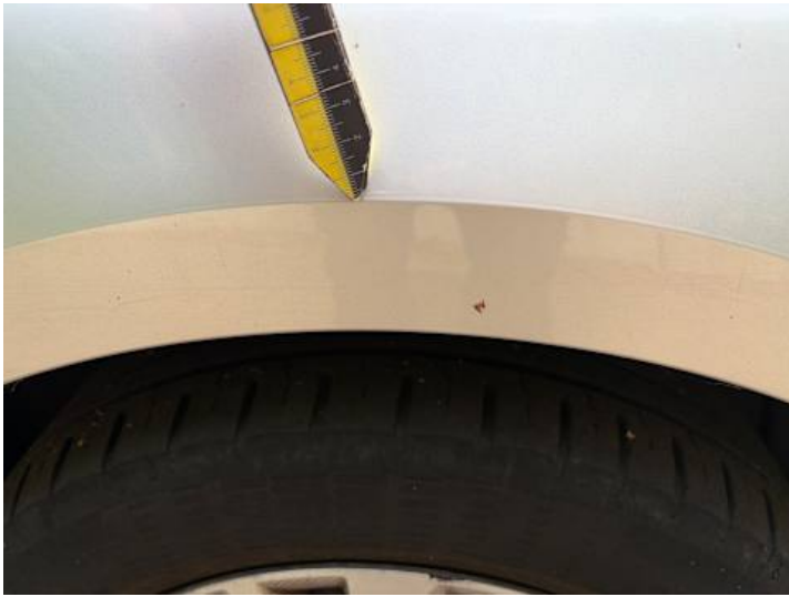
Kotflügel vorne rechts (Lackschaden, Kratzer)
