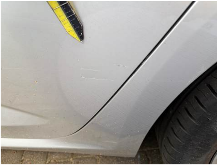
Türe hinten links (Lackschaden, Kratzer)
