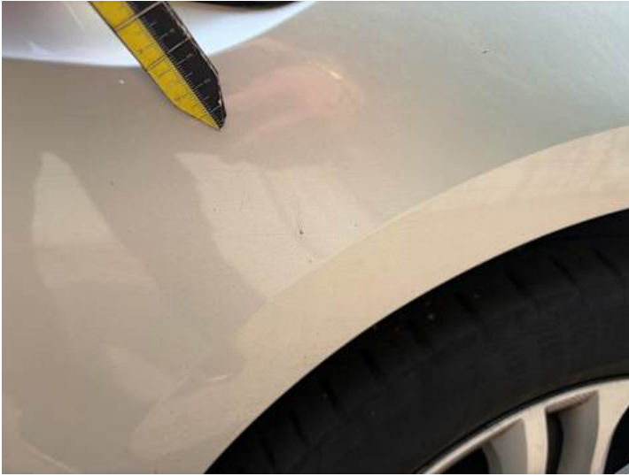
Kotflügel vorne rechts (Lackschaden, Kratzer)
