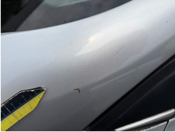
Dach (Lackschaden, Steinschlag)
