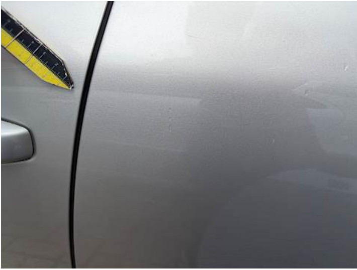
Türe hinten links (Lackschaden, Kratzer)
