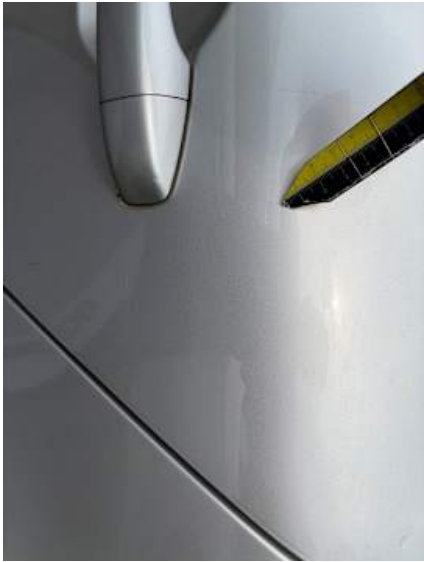
Türe hinten links (Lackschaden, Kratzer)
