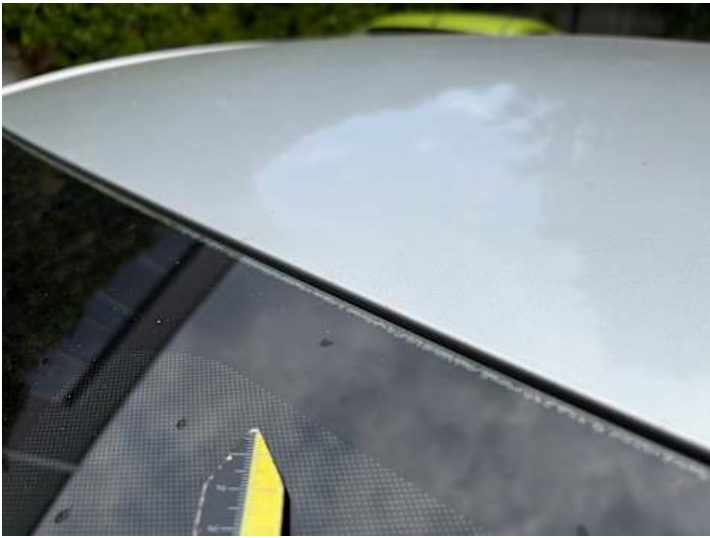
Dach (Lackschaden, Steinschlag)
