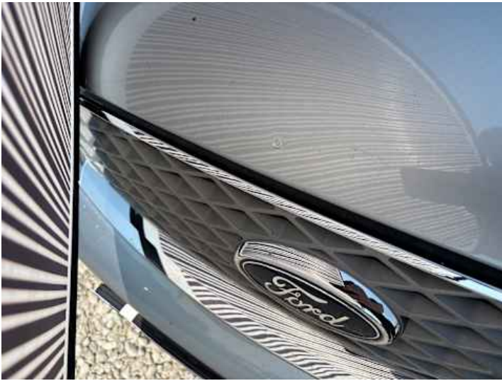
Motorhaube (Lackschaden, Delle, Kratzer)
