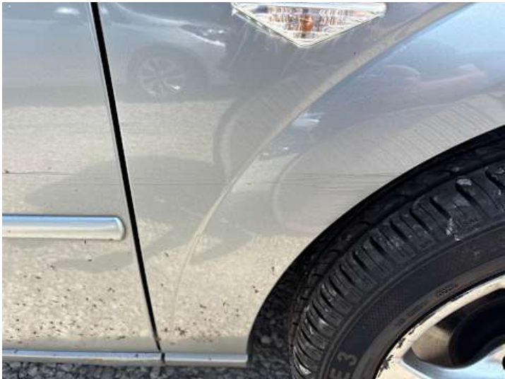
Kotflügel vorne rechts (Verformung, Kratzer, Lackschaden)
