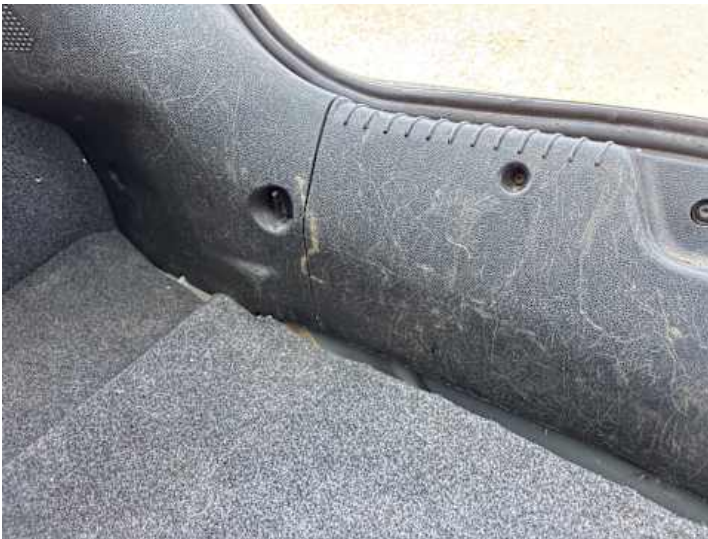
Innenraum (Verschmutzung, Kratzer)
