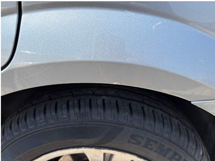
Seitenteil hinten links (Kratzer, Lackschaden, Rost)
