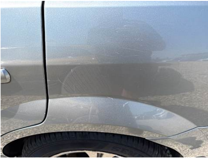
Seitenteil hinten links (Kratzer, Lackschaden, Rost)
