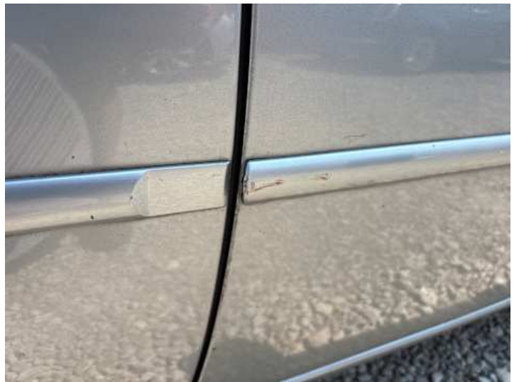
Beifahrertür (Kratzer, Lackschaden)
