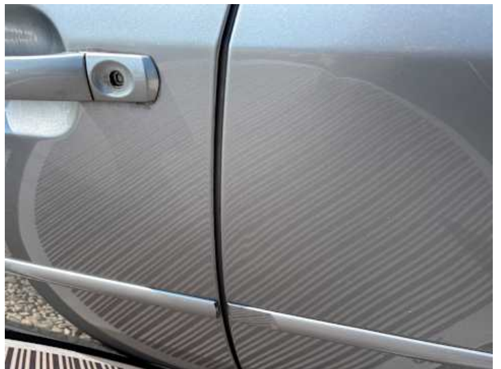
Türe hinten links (Kratzer, Lackschaden, Verformung)
