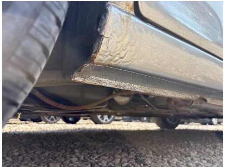
Schweller rechts (Lackschaden, Rost, Unsachgemäß instand gesetzt)
