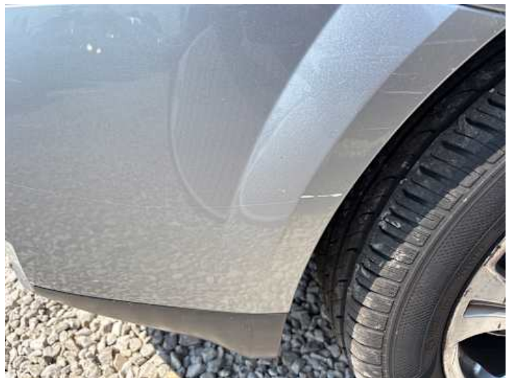
Stoßstange vorne (Lackschaden, Kratzer)
