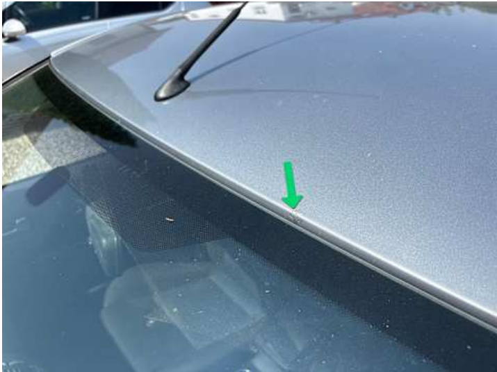
Dach (Lackschaden, Unsachgemäß instand gesetzt)
