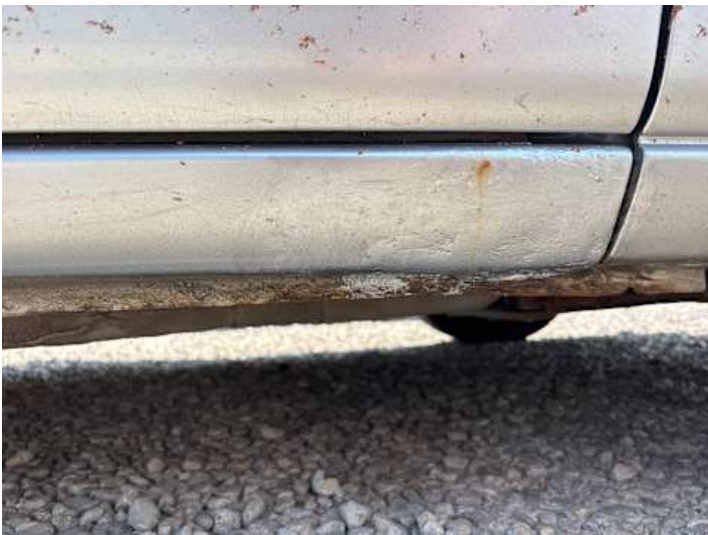
Schweller rechts (Lackschaden, Rost, Unsachgemäß instand gesetzt)
