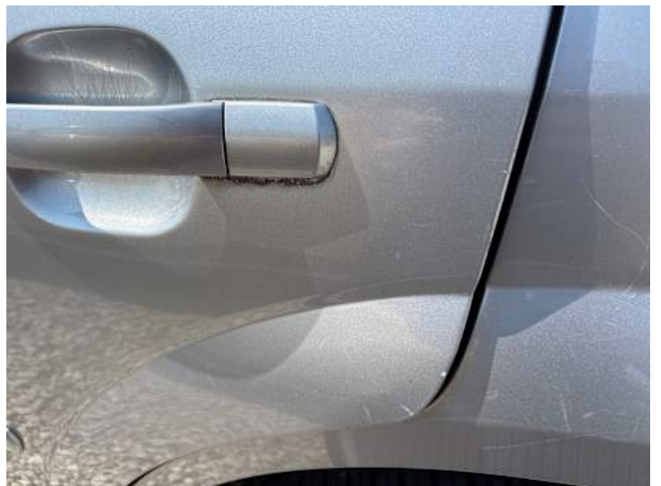
Türe hinten links (Kratzer, Lackschaden, Verformung)
