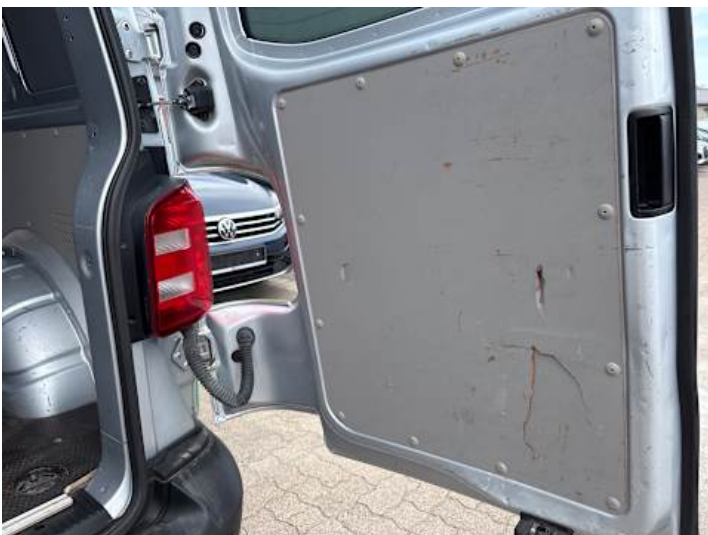
Innenraum (Kratzer, Verschleiß, Riss/Bruch)
