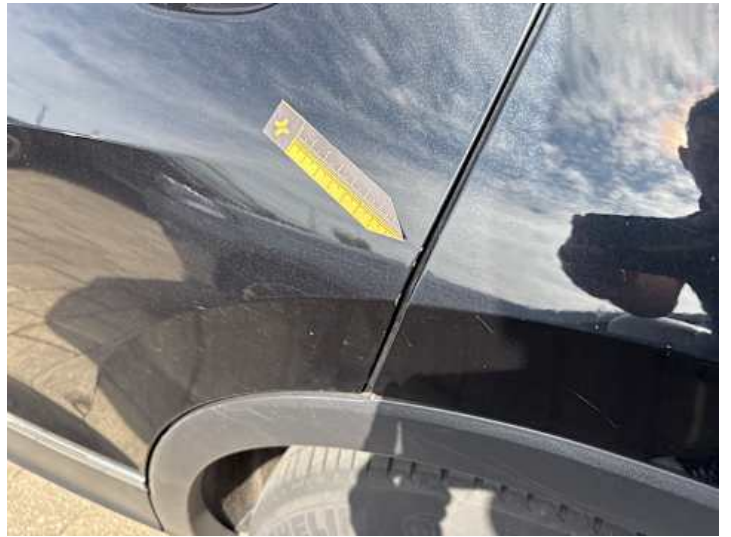
Türe hinten links (Lackschaden)
