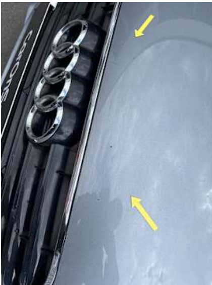
Motorhaube (Kratzer, Rost)
