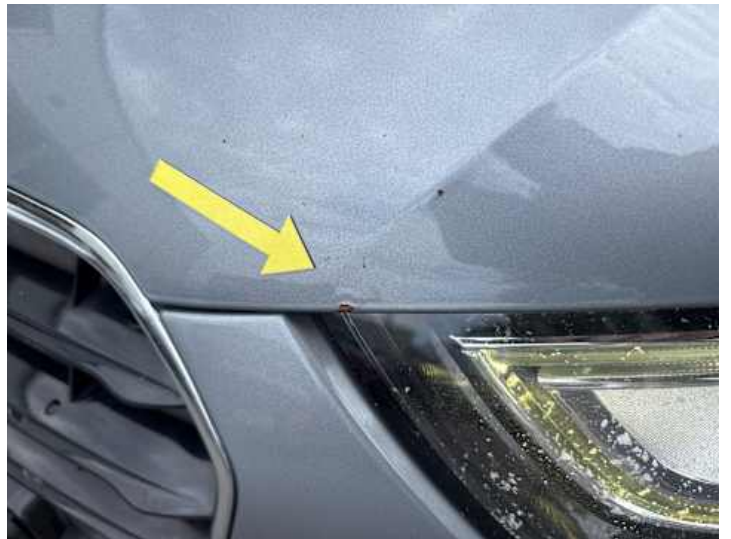
Motorhaube (Kratzer, Rost)
