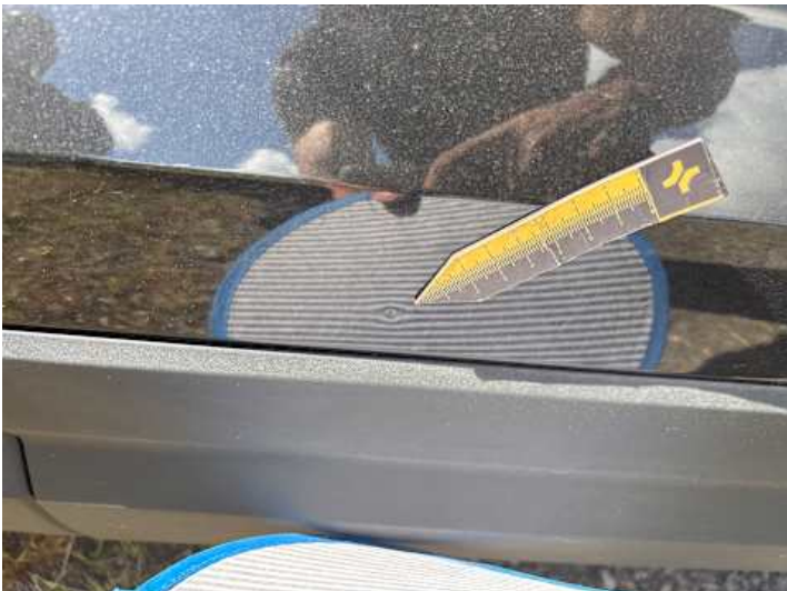
Beifahrertür (Kratzer, Delle)
