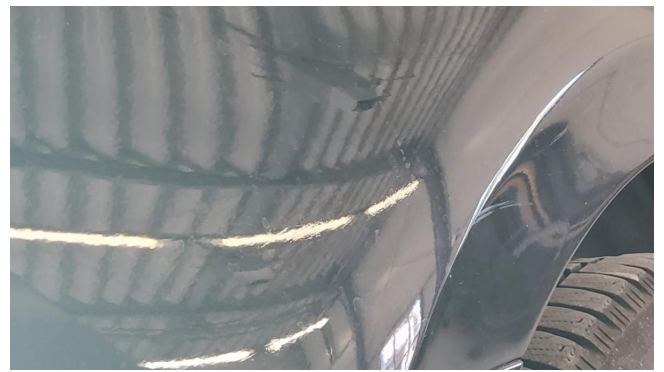
Fondseite rechts - nass schleifen / polieren
