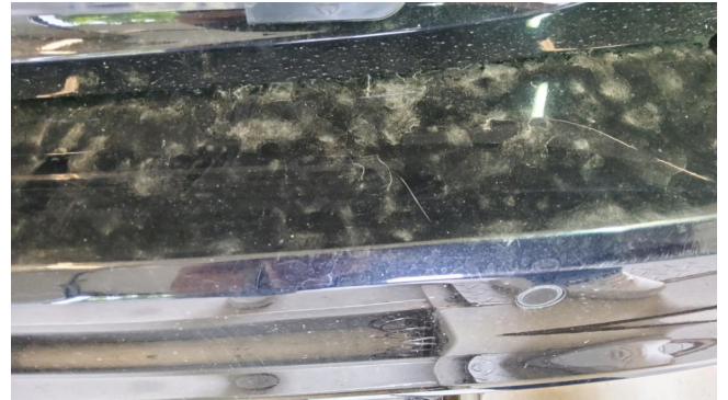
Stoßfänger hinten - nass schleifen/ polieren
