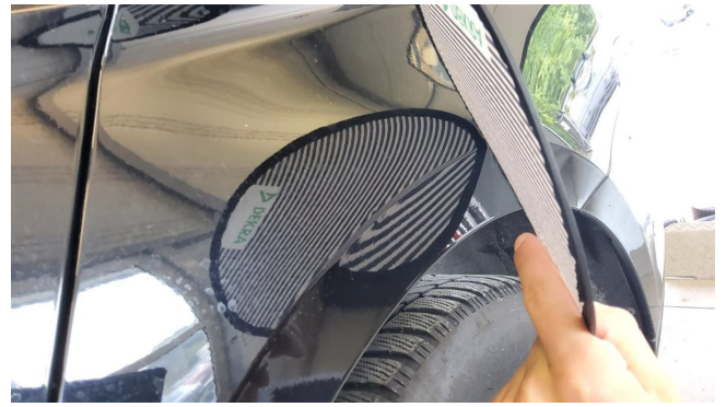
Fondseite links - Delle entfernen
