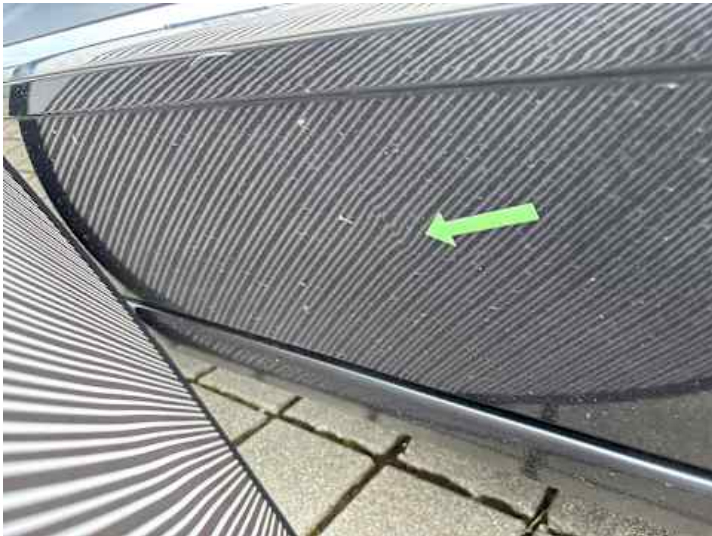
Fahrtür (Delle, Kratzer)
