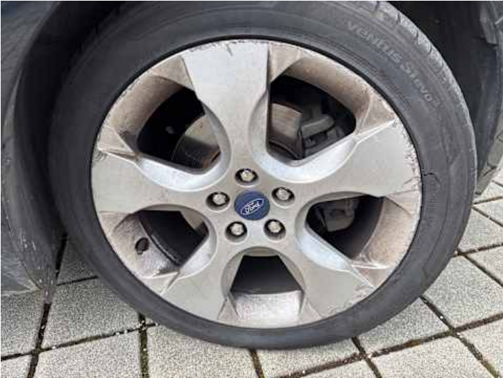
Rad (Kerben, Kratzer, Riss/Bruch)
