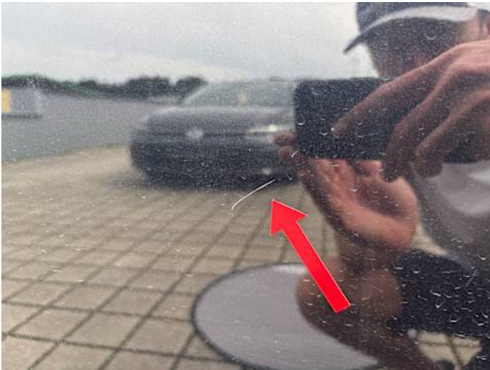
Fahrtür (Delle, Kratzer)
