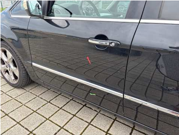
Fahrtür (Delle, Kratzer)
