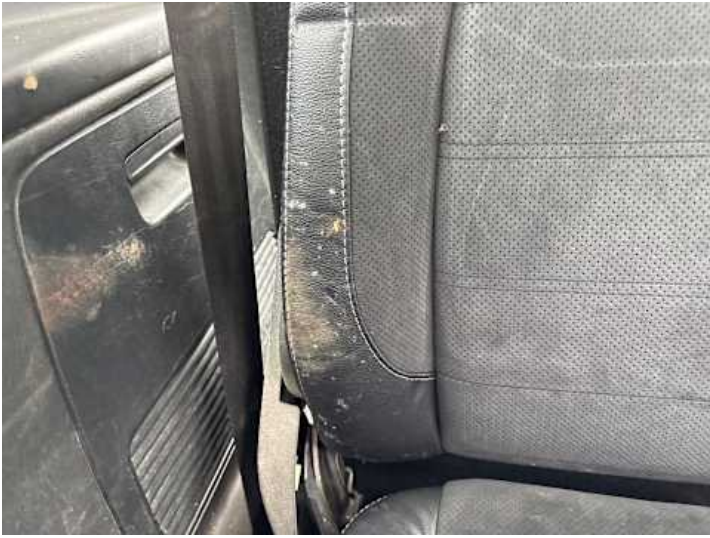
Innenraum (Anderer Schaden): Schimmelbefall
