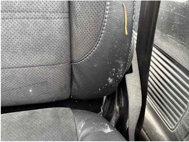
Innenraum (Anderer Schaden): Schimmelbefall
