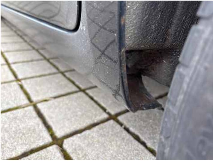
Schweller links (Rost)
