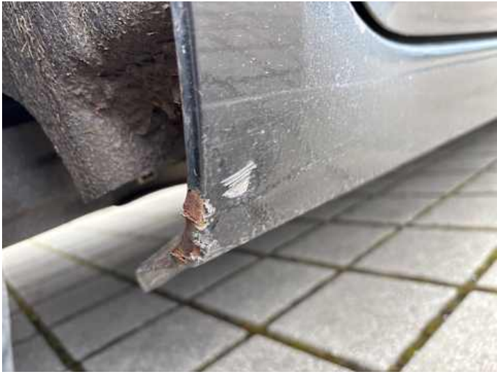
Schweller rechts (Rost)
