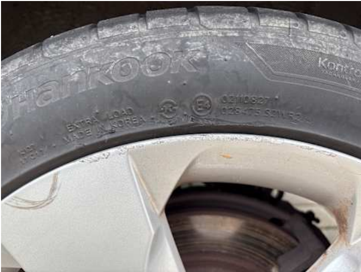
Rad (Kerben, Kratzer, Riss/Bruch)
