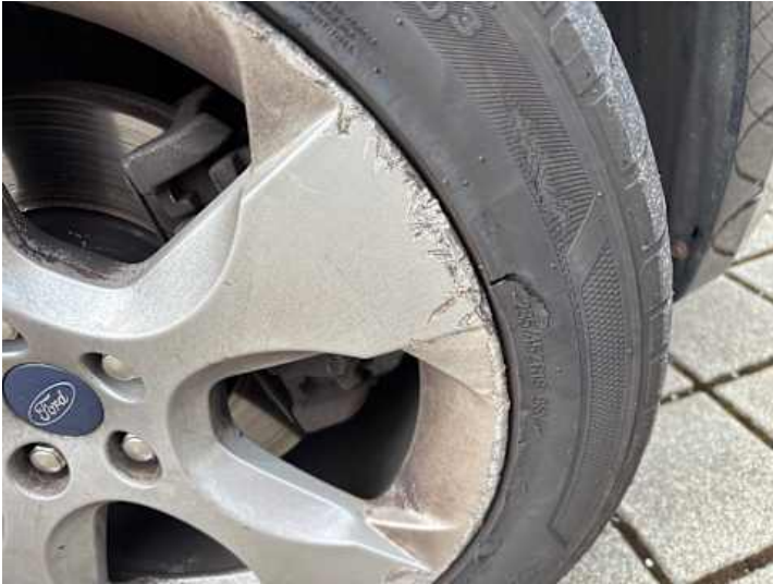
Rad (Kerben, Kratzer, Riss/Bruch)
