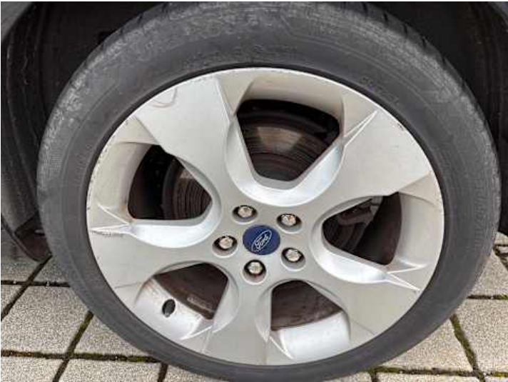
Rad (Kerben, Kratzer, Riss/Bruch)
