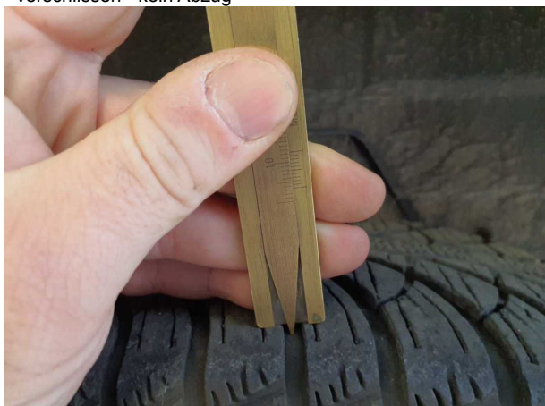
Beschädigung #1: Rad/Reifen: Reifensatz komplett (Winterreifen) - verschlissen - kein Abzug
