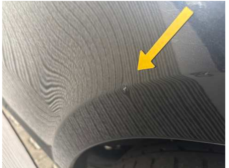
Seitenteil hinten links (Delle, Steinschlag)
