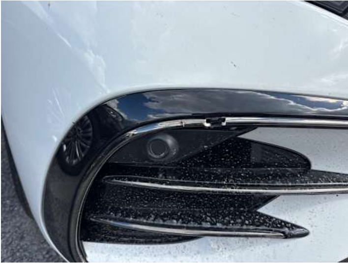
Stoßstange vorne (Riss/Bruch, Kratzer)
