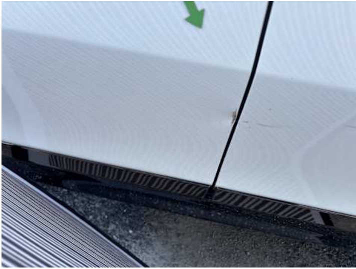
Türe hinten rechts (Kratzer, Lackschaden, Delle)
