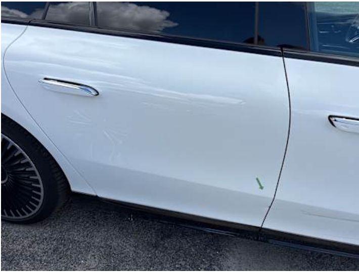
Türe hinten rechts (Kratzer, Lackschaden, Delle)
