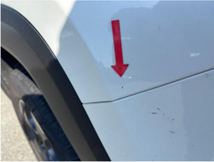
Kotflügel vorne rechts (Lackschaden)
