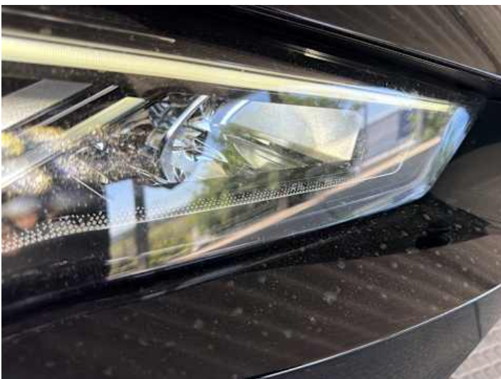
Scheinwerfer (rechts) (Steinschlag)
