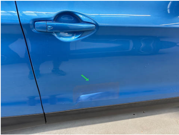
Beifahrertür (Verformung, Kratzer)
