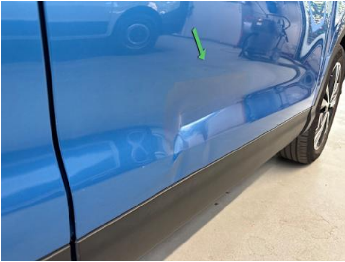
Beifahrertür (Verformung, Kratzer)
